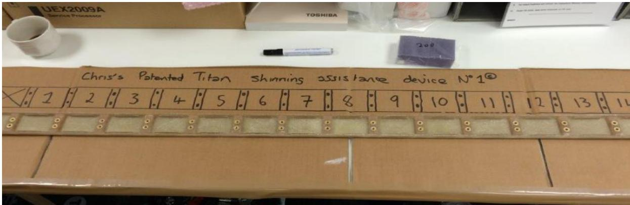
Slika 19. Predodžba vodilica za umetanje limova. Izvorno autor.
