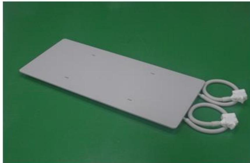
Slika 30. Predodžba Spine coil-a (zavojnica za snimanje kralježnice)
