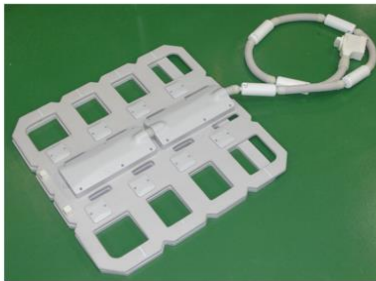
Slika 29. Predodžba Body coil-a. (zavojnica za snimanje grudnog koša, abdomena i zdjelice) (slika iz Install Titan 3 rd priručnika)
