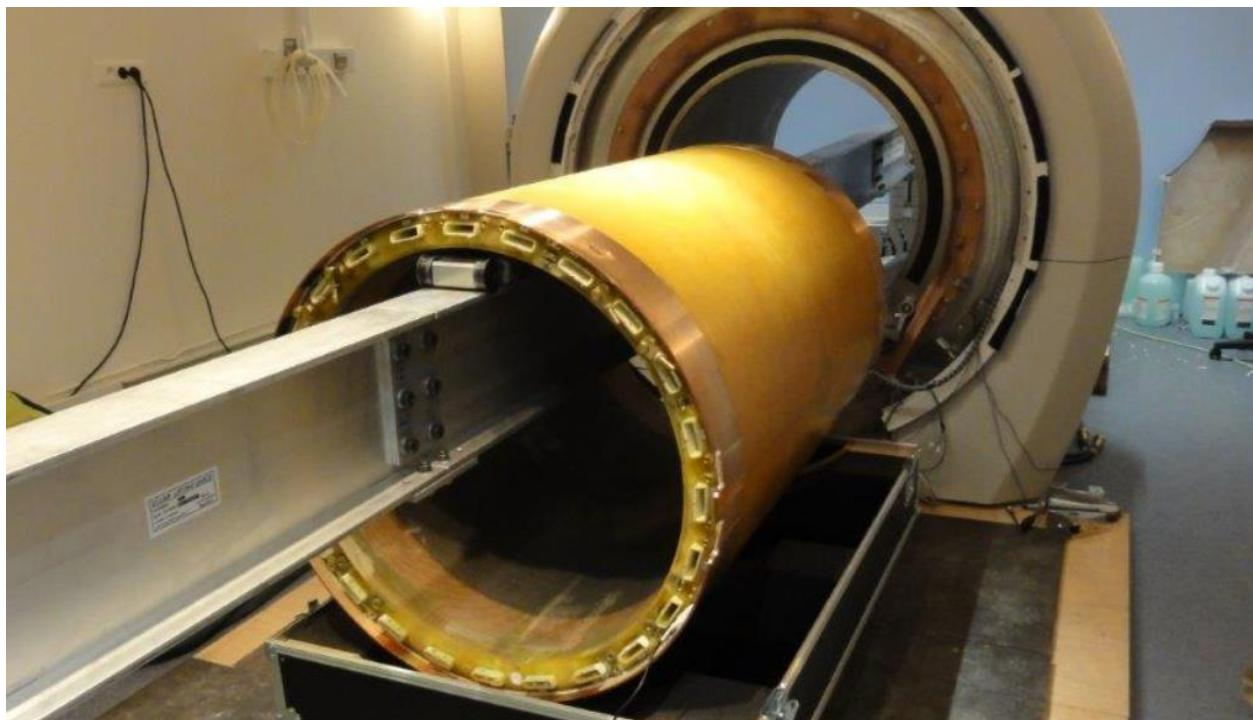
Slika 4. Predodžba ugradnje gradijentne zavojnice. Izvorno autor.
