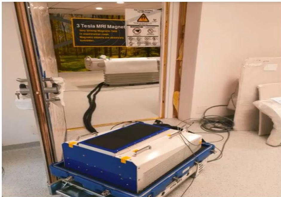
Slika 16. Predodžba MPSU/uređaj za dizanje i spuštanje magnetskog polja.
