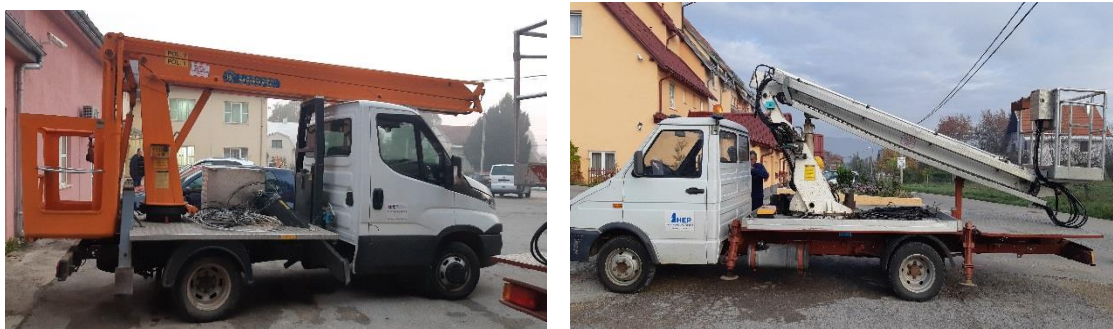
Slika 11. Prikaz hidraulične auto-platforme s košarom
