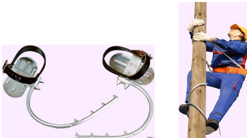
Slika 9. Prikaz penjalica i njihove uporabe na drvenim stupovima
