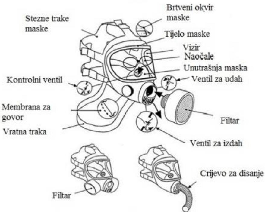
Slika 5: Dijelovi maska za cijelo lice [1]
