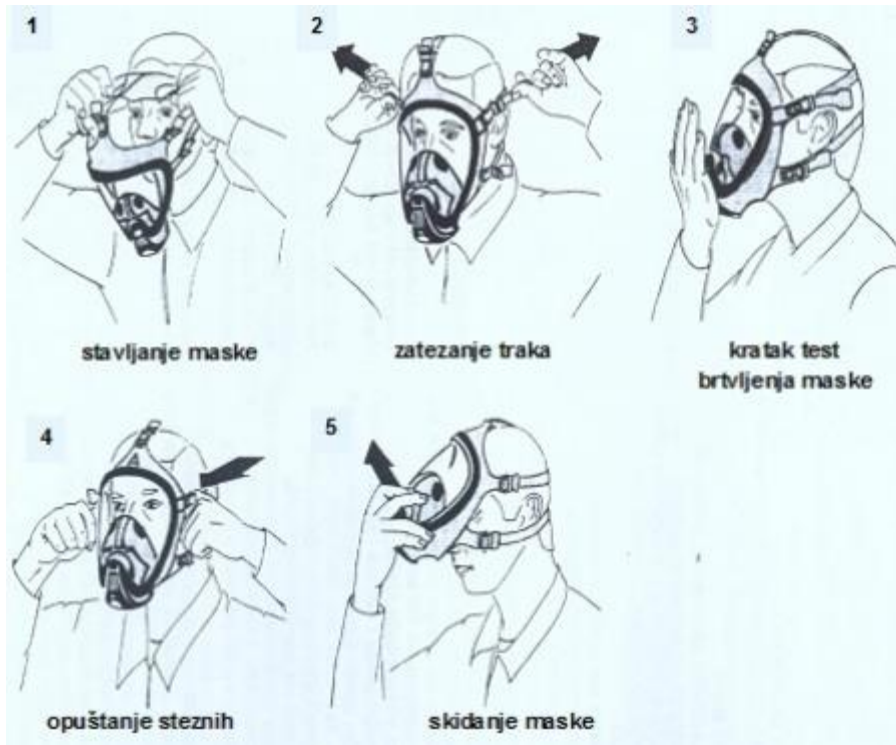
Slika 6: Pravilno stavljanje i skidanje maske za cijelo lice [1]
