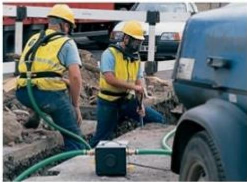
Slika 26: Cijevni uređaji s dovodom čistog zraka pomoću puhalo ili mijeha [1]
