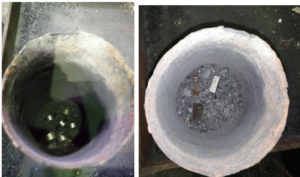
Slika 23 - Pozicioniranje uzoraka u posudu za pougljičavanje [9]
