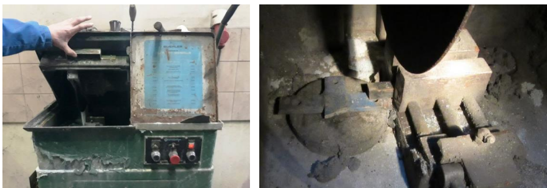
Slika 27 - Visokobrzinsko rezanje štapova [9]
