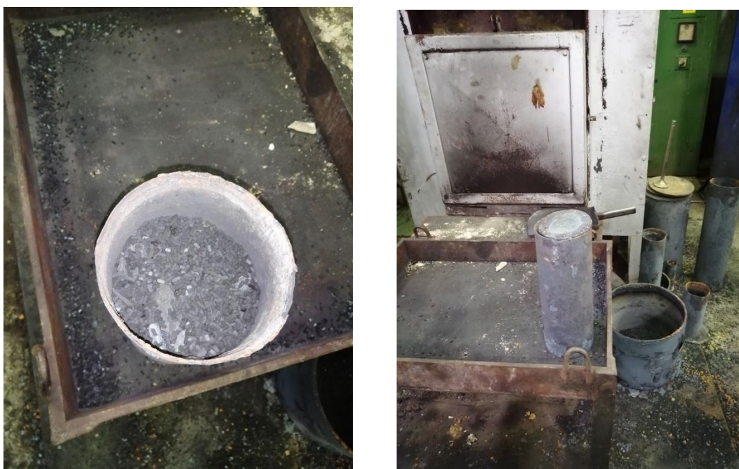
Slika 24 - Prikaz zatvorene posude za pougljičavanje [9]
