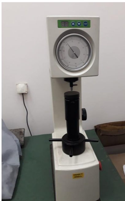
Slika 29 - Mjerni uređaj za ispitivanje tvrdoće [9]
