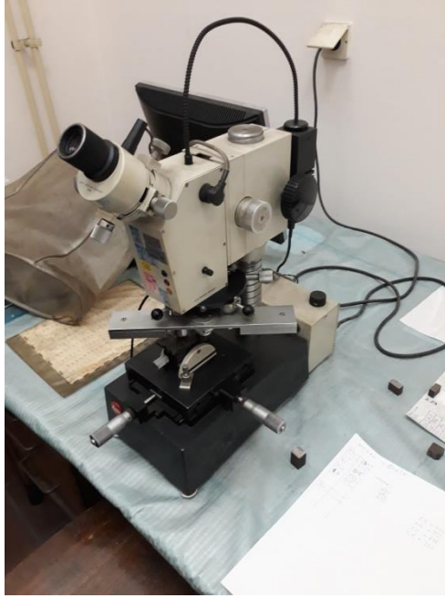
Slika 30 – LEITZ Durimet 2 mikroskop [9]
