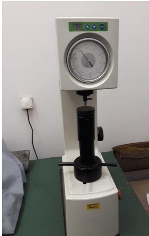
*Slika 27. Mjerni uređaj za ispitivanje tvrdoće [10]*
