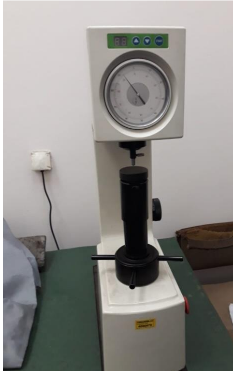
Slika 27. Mjerni uređaj za ispitivanje tvrdoće [10]
