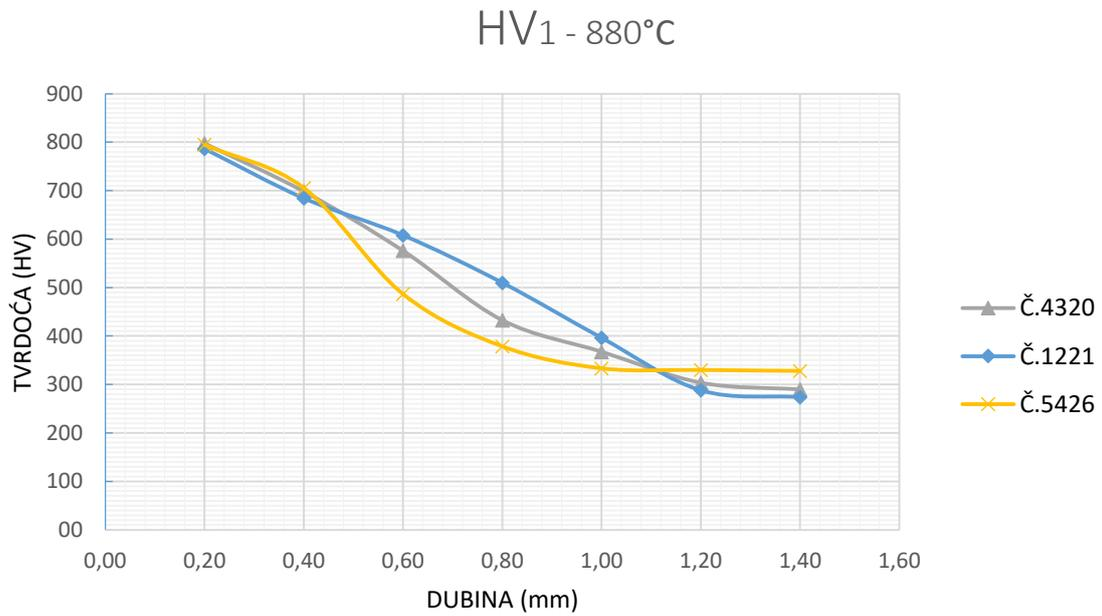
Slika 38. Dijagram mikrotvrdoće Č.1221, Č.4320 i Č.5426 na temperaturi pougljičenja 880°C
