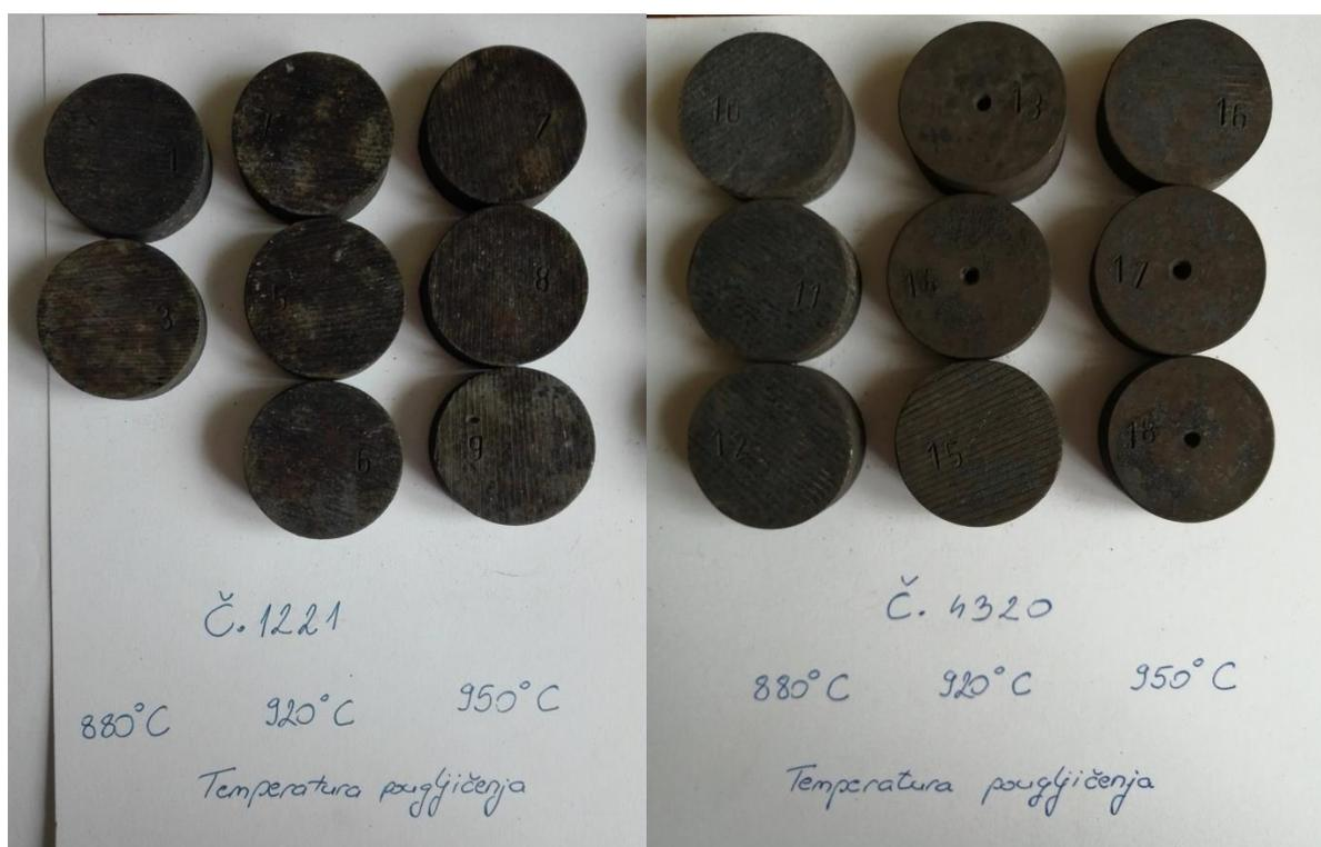
Slika 23. Uzorci Č.1221 i Č.4320 nakon postupka cementacije [10]
