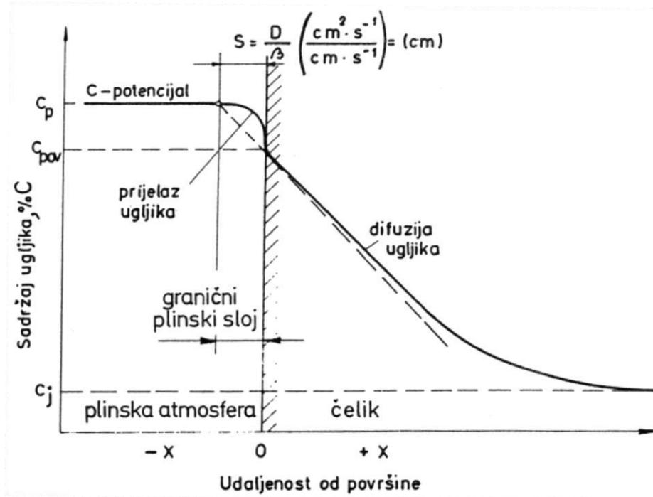
Slika 5. Prikaz procesa pougljičenja čelika [3]
