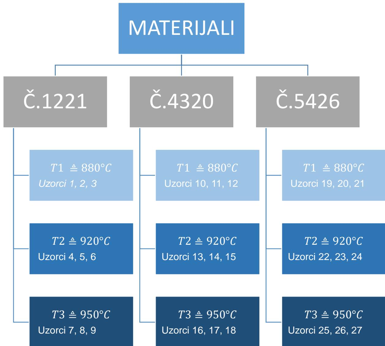
Slika 18. Plan eksperimentalnog dijela
