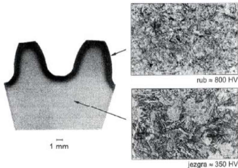
*Slika 2. Mikrostruktura cementiranog zupčanika izrađenog iz čelika 16MnCr5 [2]*
