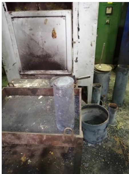
Slika 21. Prikaz pripremljene čelične kutije za proces pougljičenja [10]
