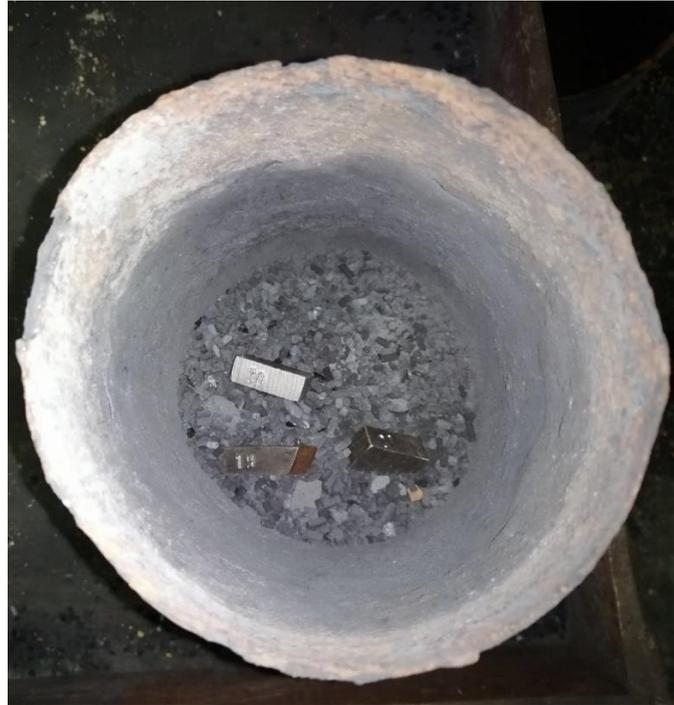
*Slika 20. Priprema i pozicioniranje uzoraka u čeličnu kutiju [10]*
