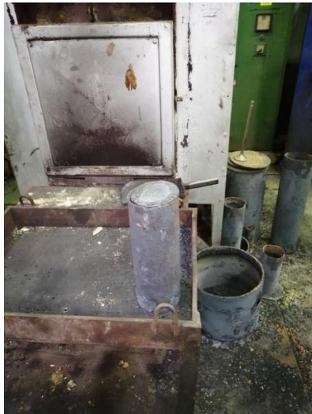
*Slika 21. Prikaz pripremljene čelične kutije za proces pougljičenja [10]*
