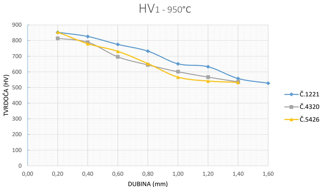
*Slika 40. Dijagram mikrotvrdoće Č.1221, Č.4320 i Č.5426 na temperaturi pougličanja 950°C*
