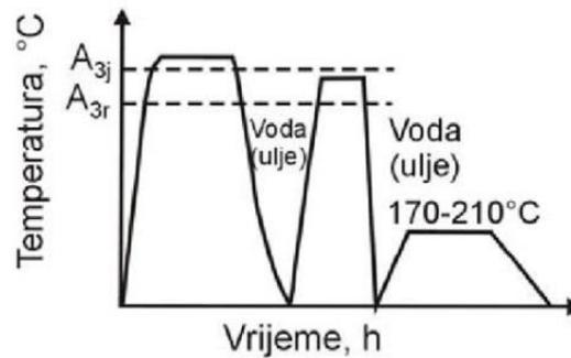
Slika 16. Dvostruko kaljenje [6]
