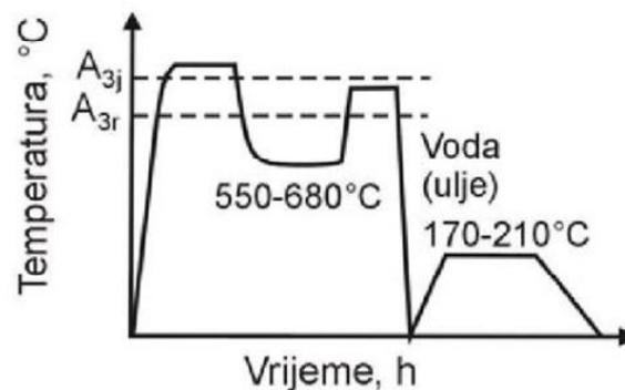
*Slika 15. Jednostruko kaljenje ruba nakon izotermičke pretvorbe jezgre [6]*
