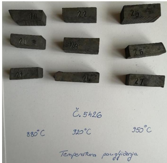
*Slika 24. Uzorci Č.5426 nakon postupka cementacije [10]*
