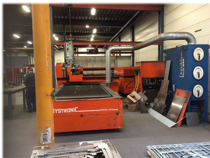
Slika 17 Laser za rezanje lima
