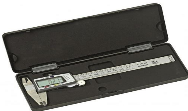
Sl. 41. Digitalna pomična mjerka [35]
