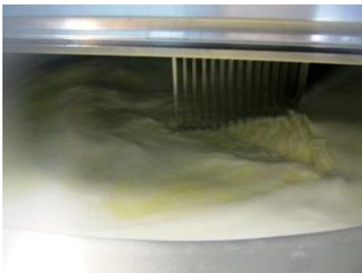
Slika 9. Dogrijavanje sirnog zrna (Izvor: fotografija, D. Petrović)
