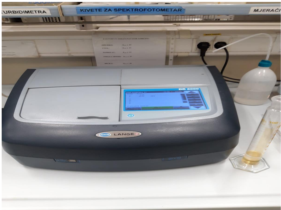
Slika 8. UV Spektrofotometar i menzura za pripremu otopine
