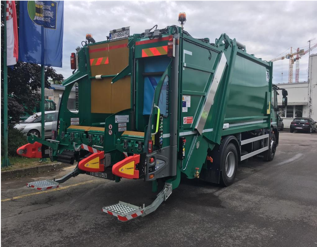
Slika 5. Vozilo za istovremeni prijevoz dvije vrste otpada
