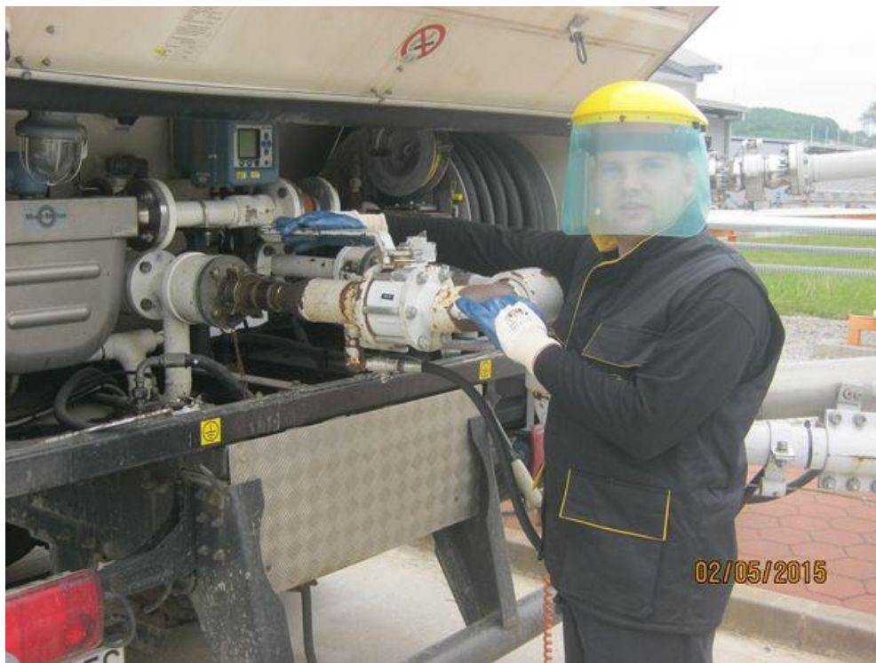
Slika 31. Radnik sa zaštitnom opremom prilikom spajanja istakačkih ruku
