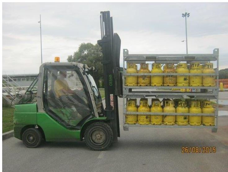
Slika 52. Odlaganje kaveza na skladište plinskih boca
