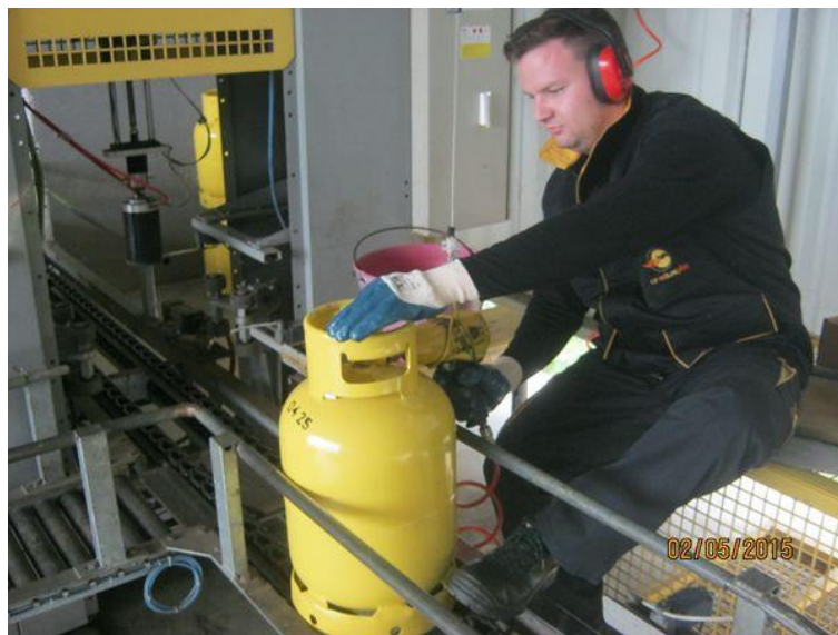
Slika 59. Sigurnosno zatvaranje boca
