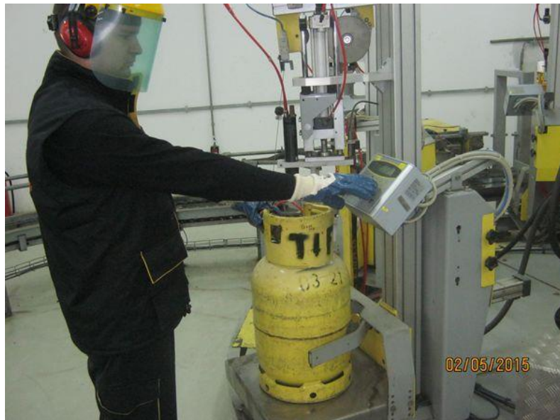
Slika 58. Punitelj plinskih boca
