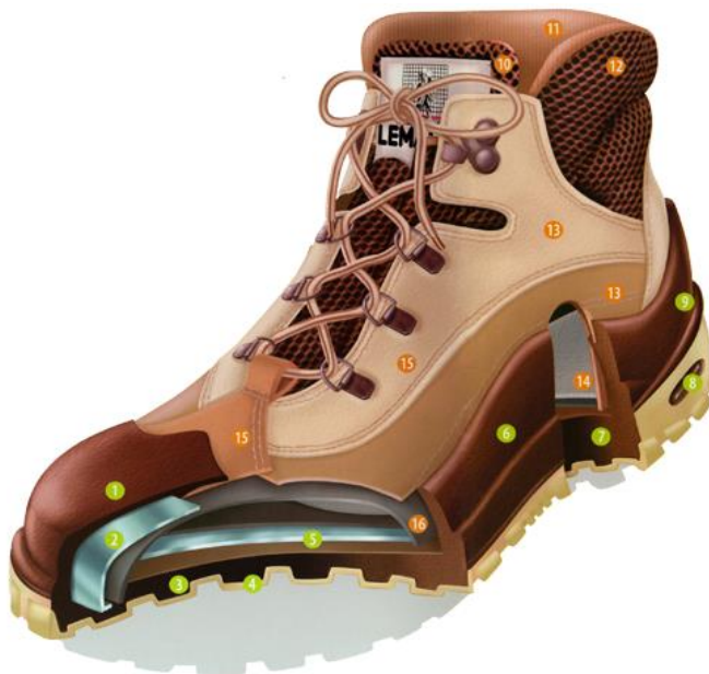
Slika 22. Presjek zaštitne cipele
