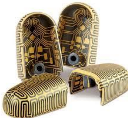
Slika 14. Primjer predmeta izrađenih MID tehnologijom
