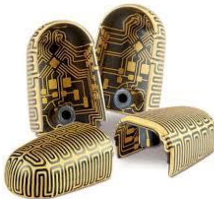
Slika 14. Primjer predmeta izrađenih MID tehnologijom
