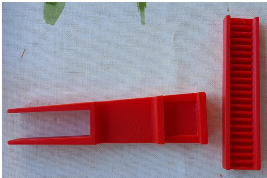
Slika 29: Nosač zubne letve i zubna letva prednja strana
