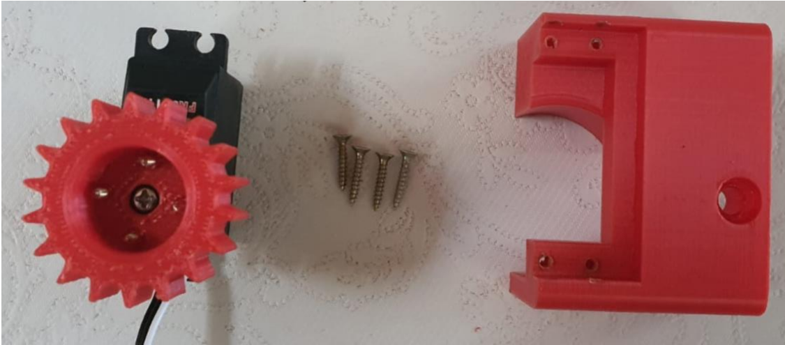
Slika 22: Motor, vijci i nosač vilica
