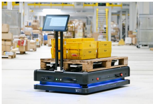
Slika 1: Testni mobilni robot u hrvatskoj pošti
