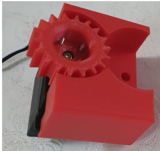
Slika 23: Spojeni motor i nosač vilica
