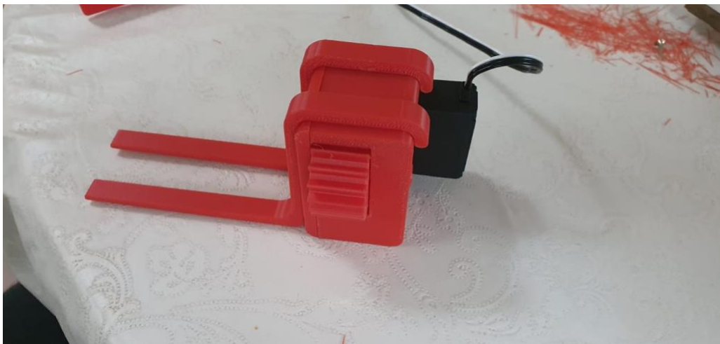
Slika 37: Sastavljen nosač i vilice
