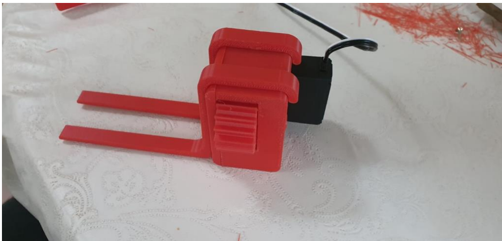
Slika 37: Sastavljen nosač i vilice
