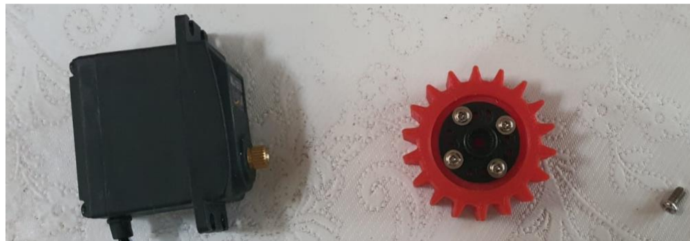
Slika 20: Prirubnica montirana na pogonski zupčanik
