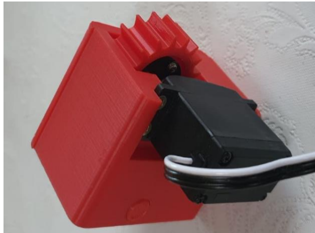
Slika 27: Sastavljen nosač vilica stražnja strana
