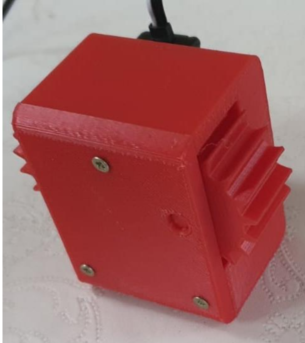
Slika 26: Sastavljen nosač vilica prednja strana
