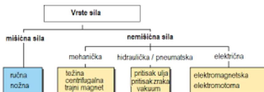
Slika 3. Podjela sile stezanja prema načinu ostvarivanja [1]
