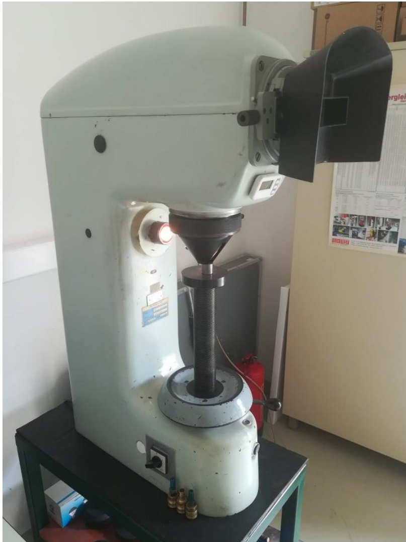
Slika 20. Uređaj za ispitivanje tvrdoće
