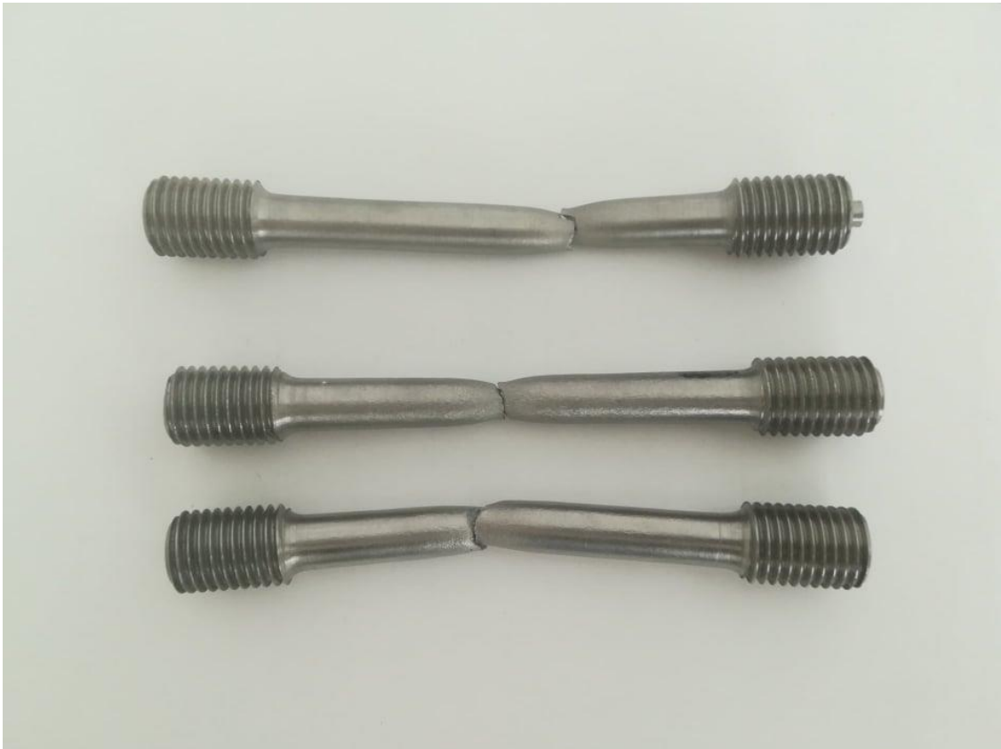
Slika 19. Epruvete nakon loma
