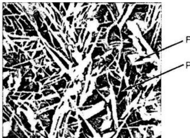
Slika 5. Widmannstättenova mikrostruktura čeličnog lijeva [3]
