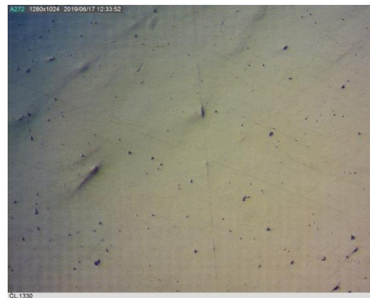
Slika 26. Ispitivani materijal u poliranom stanju uvećan 200x
