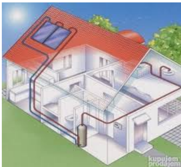
Slika 13. Solarni sustav za toplu vodu
