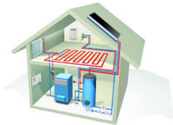
Slika 9. Kombinacija radijatorskog i podnog toplovnog centralnog grijanja
