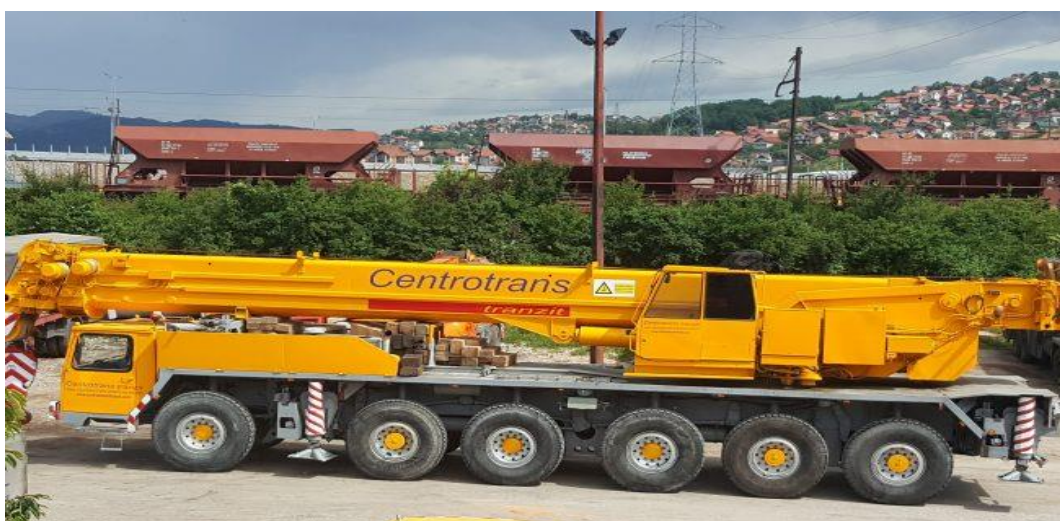
Slika 11. Autodizalica za teške terete
