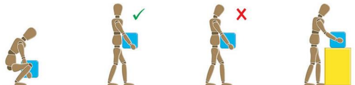
Slika 2. Pravilno i nepravilno podizanje tereta [29]
