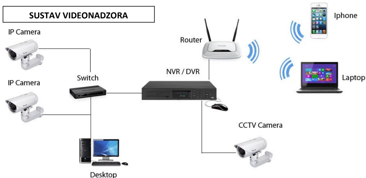
Slika 6. Predodžba sustava video nadzora: Izvor https://svezavideonadzor.rs/video-nadzor-sve-sto-treba-da-znate/
