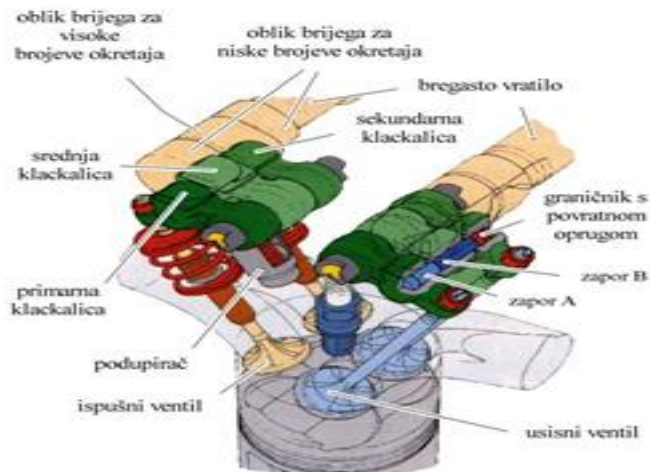
Slika 6. Varijabilno podizanje ventila
