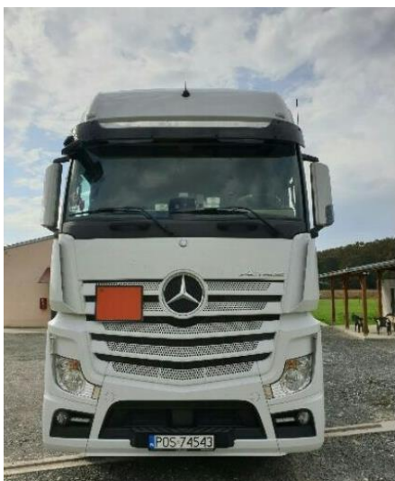
Sl. 5. Označavanje vozila listicama opasnosti na prednjoj strani vozila [9]
