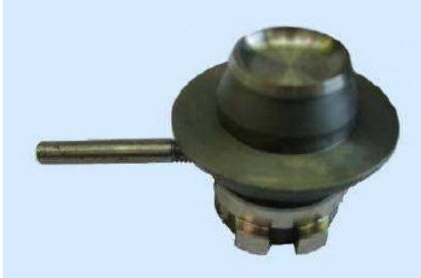
Slika 15. a) Dno predkalupa dvodjelno [1]
