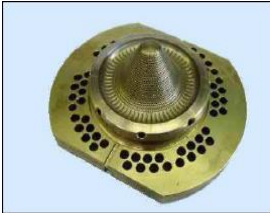
Slika 13.a) Dno kalupa (Al-bronca) [1] Slika 13. b) Dno kalupa (sivi lijev SL 25) [1]
