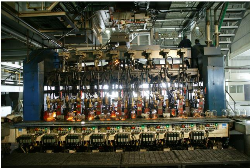
Slika 8. Linijski stroj tipa IS [3]
