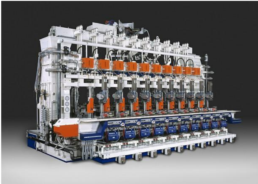
Sl. 37. Emhart I.S. 6 1/4“ linijski 10 sekcijski staklarski stroj
