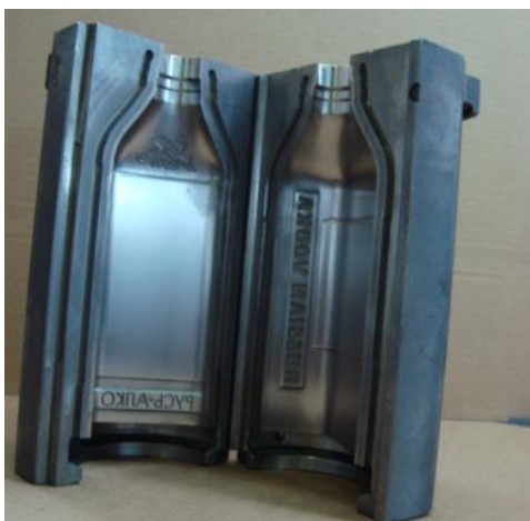
Slika 12 .a) Kalup (sivi lijev SL 25) [1]
