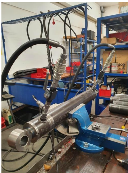
Slika 91. Priključnice spojene na cilindar.
