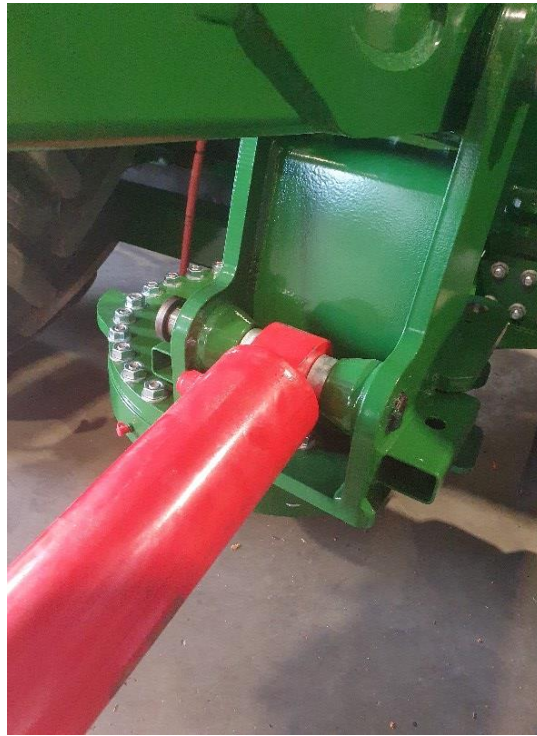
Slika 100. Montaža cilindra na ruku kranske kosilice (1).
