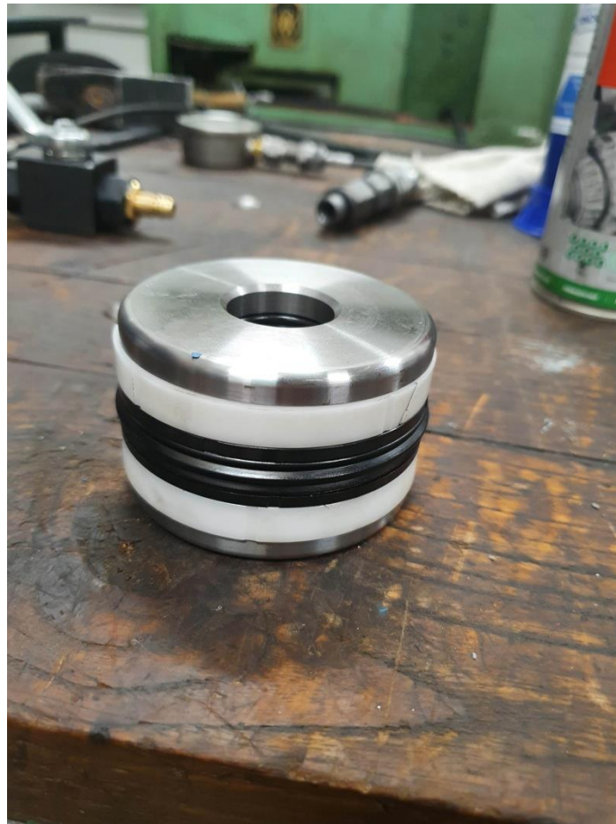
Slika 67. Brtva montirana na klip cilindra.
