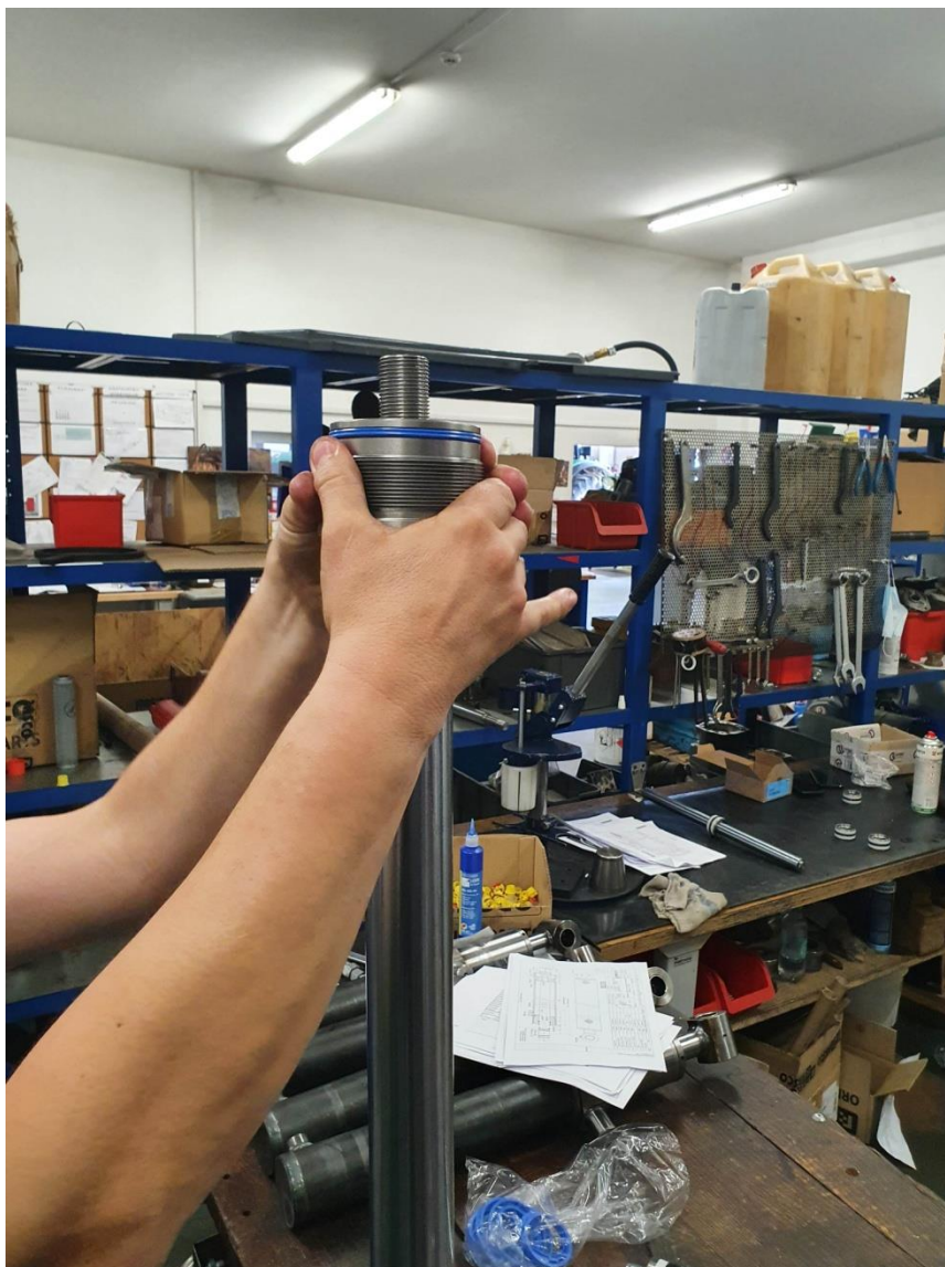
Slika 74. Montiranje usta cilindra.
