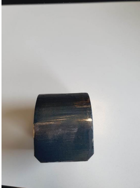
Slika 57. Površina obratka nakon rezanja na plazmi
