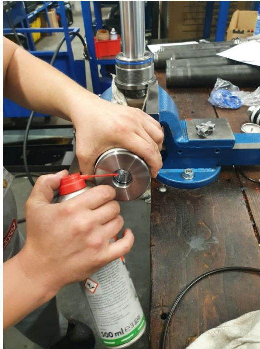
Slika 75. Podmazivanje klipa cilindra.
