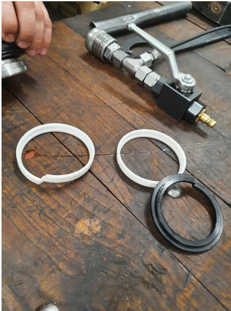
Slika 66. Brtva klipa cilindra.
