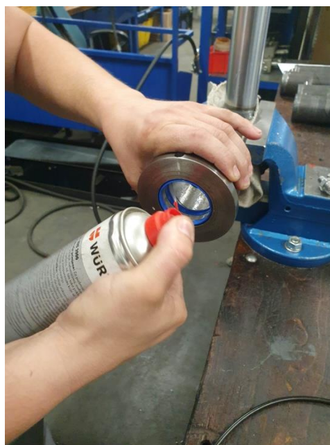
Slika 71. Podmazivanje ustiju cilindra.
