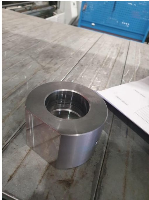
Slika 48. Izgled oka klipnjače nakon glodanja.
