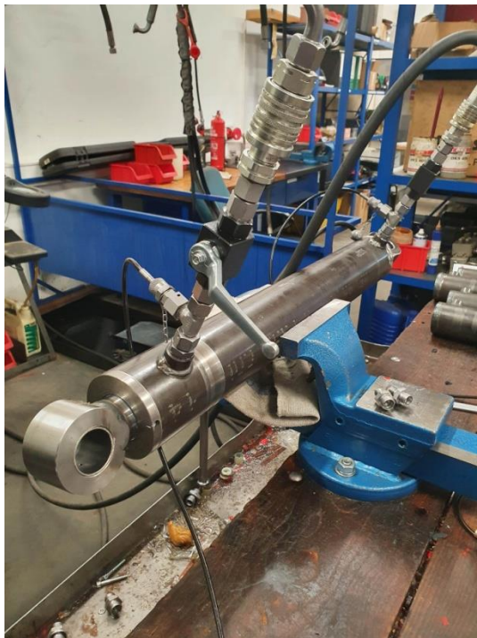
Slika 94. Zatvoren ventil priključnice (2).
