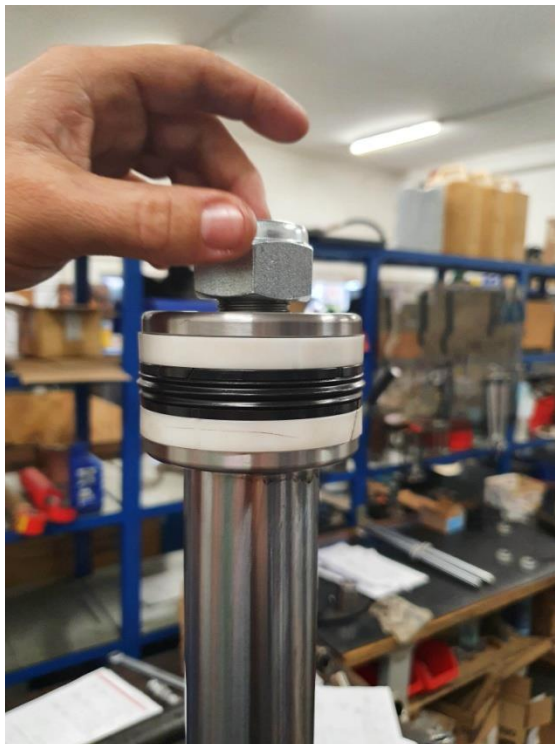
Slika 80. Sastavljanje matice na navoj klipnjače.
