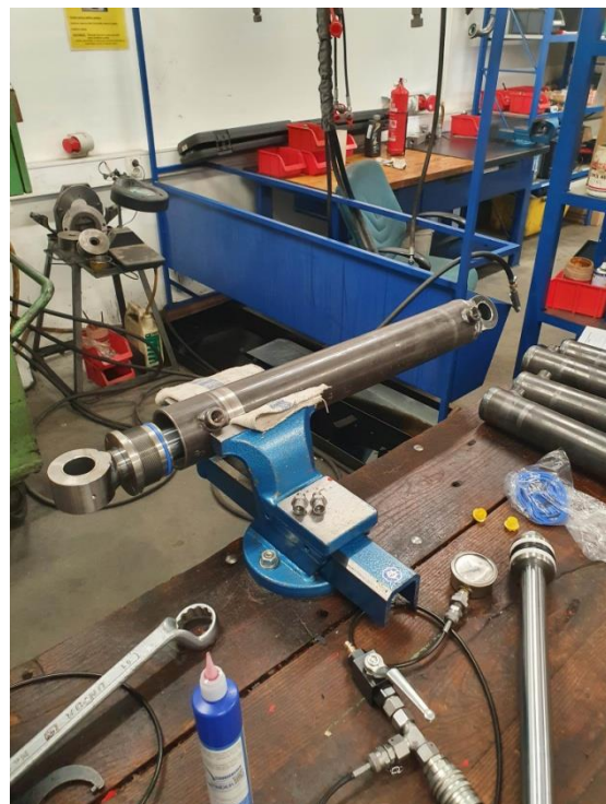
Slika 84. Stavljanje klipnjače unutar cijevi cilindra.
