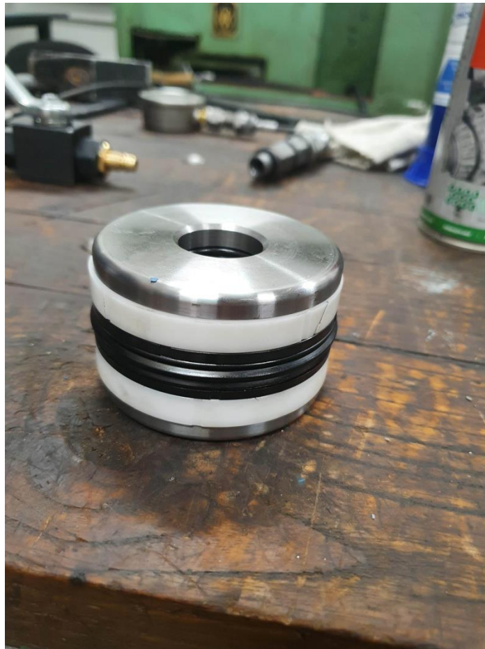
Slika 67. Brtva montirana na klip cilindra.
