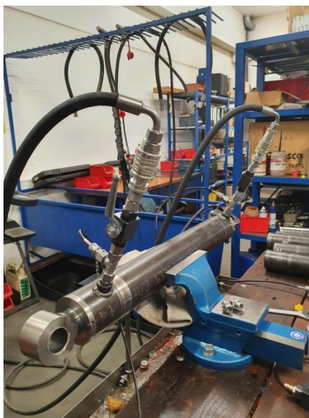
Slika 91. Priključnice spojene na cilindar.
