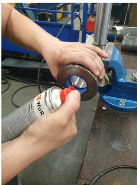
Slika 71. Podmazivanje ustiju cilindra.
