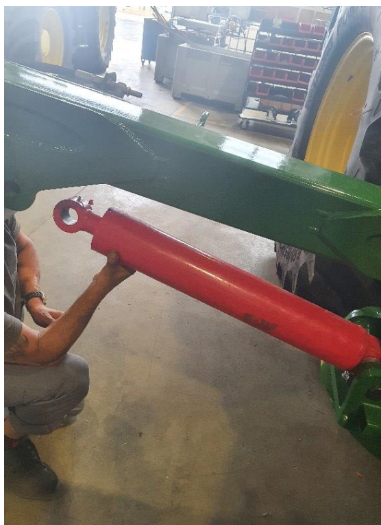
Slika 101. Montaža cilindra na ruku kranske kosilice (2).
