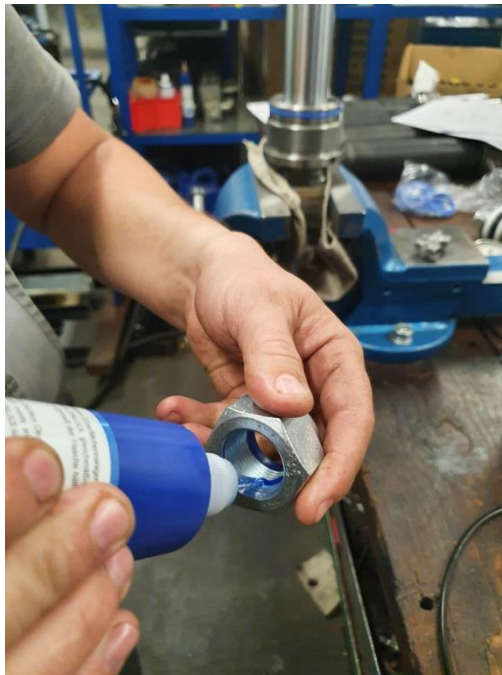
Slika 78. Nanošenje ljepila na maticu.
