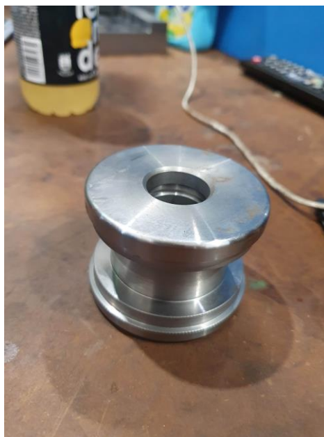
Slika 55. Klip cilindra \varnothing 100 / \varnothing 27
