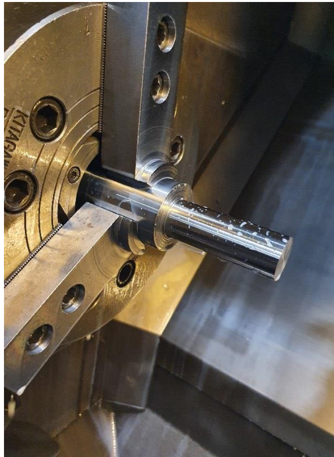
Slika 38. Tokarenje na \varnothing 27 .
