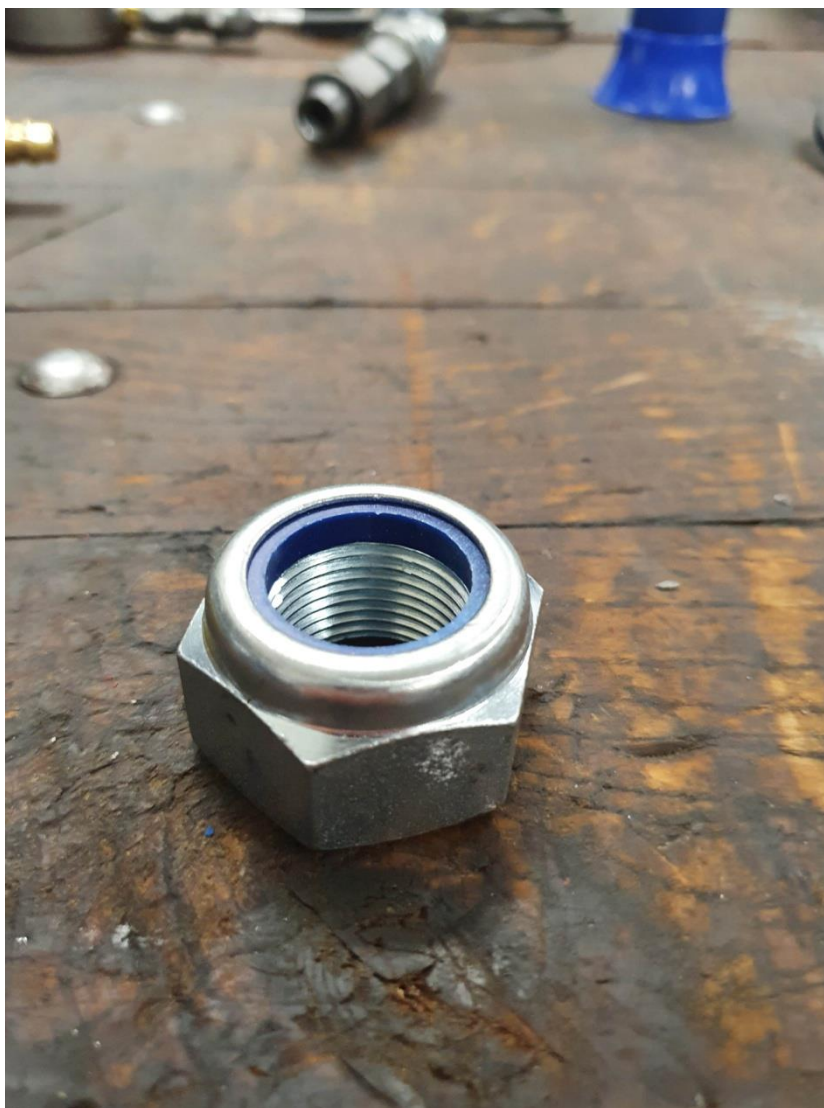
Slika 77. Matica za stezanje klipa na klipnjaču.
