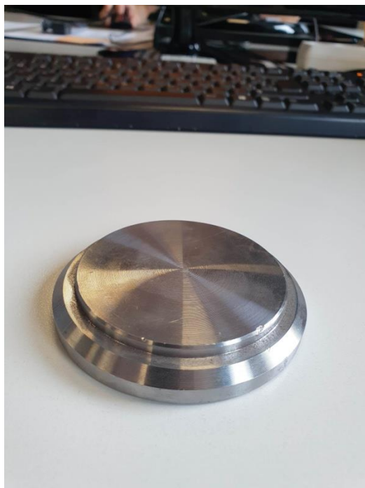
Slika 54. Poklopac cilindra \varnothing 100 / \varnothing 115 .
