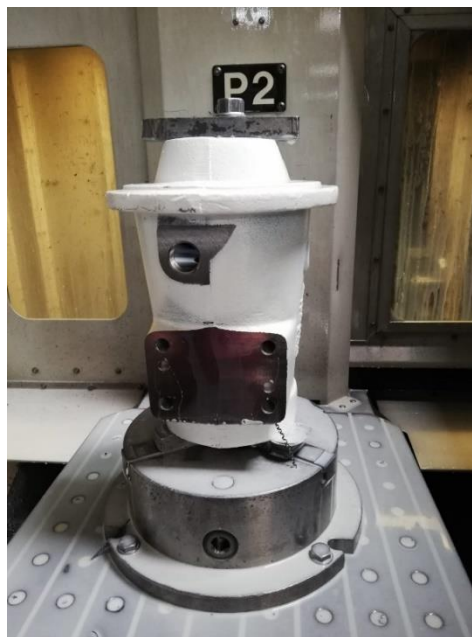
Slika 25. Prikaz prvog stezanja kućišta
