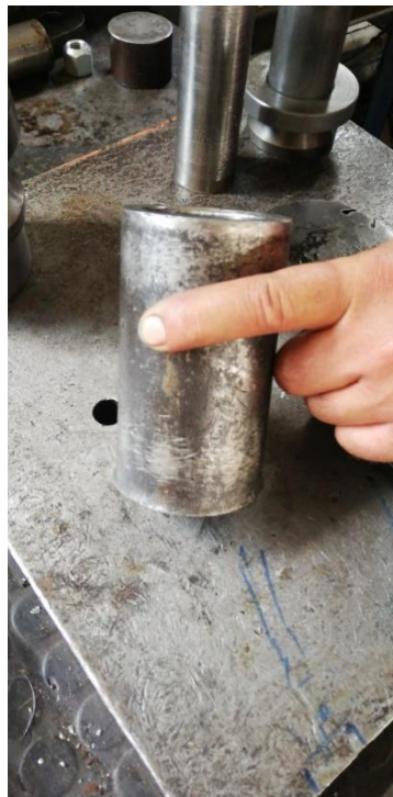
Slika 53. Naprava za uprešavanje ležaja na izlazno vratilo
