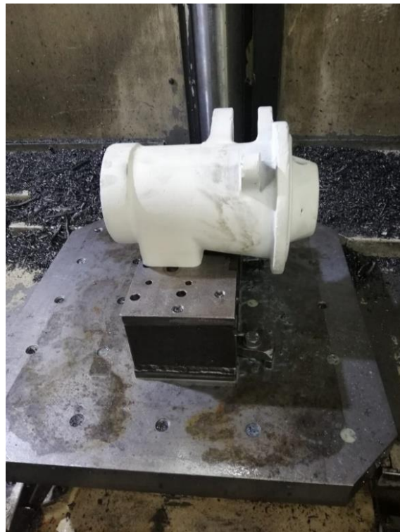
Slika 26. Prikaz drugog stezanja kućišta
