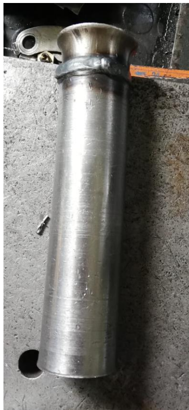
Slika 54. Naprava za uprešavanje zupčanika sa unutarnjim ozubljenjem
