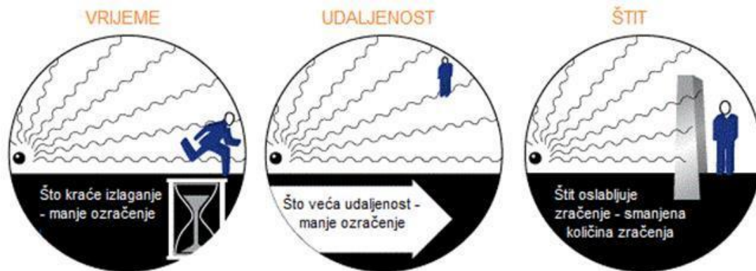
Slika 30: Načini zaštite od zračenja
