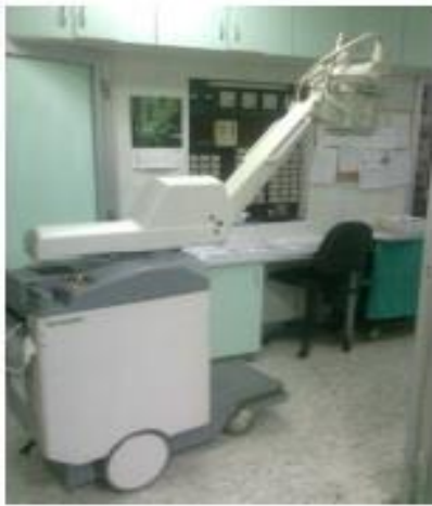
Slika 27: Pokretni digitalni rendgenski uređaji različitih izvedbi stativa
