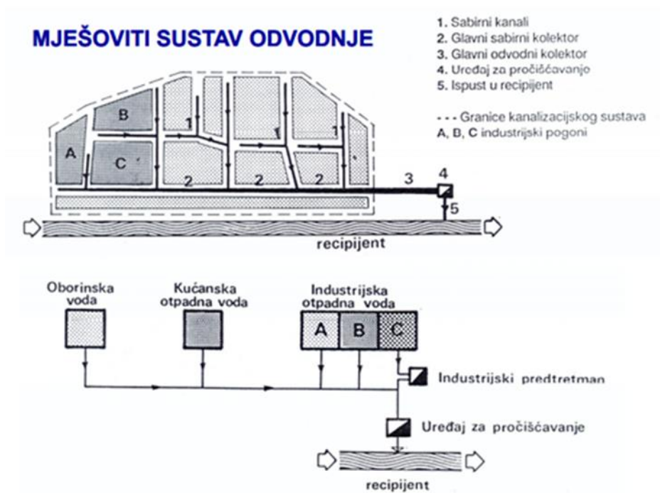
Slika 4. Prikaz mješovitog sustava odvodnje [11]
