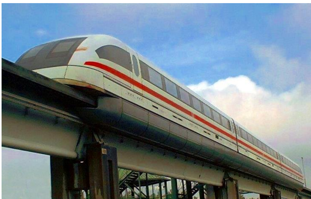
Sl. 18 Transrapid, njemačka verzija magnetno-levitacijskog vlaka [21]
