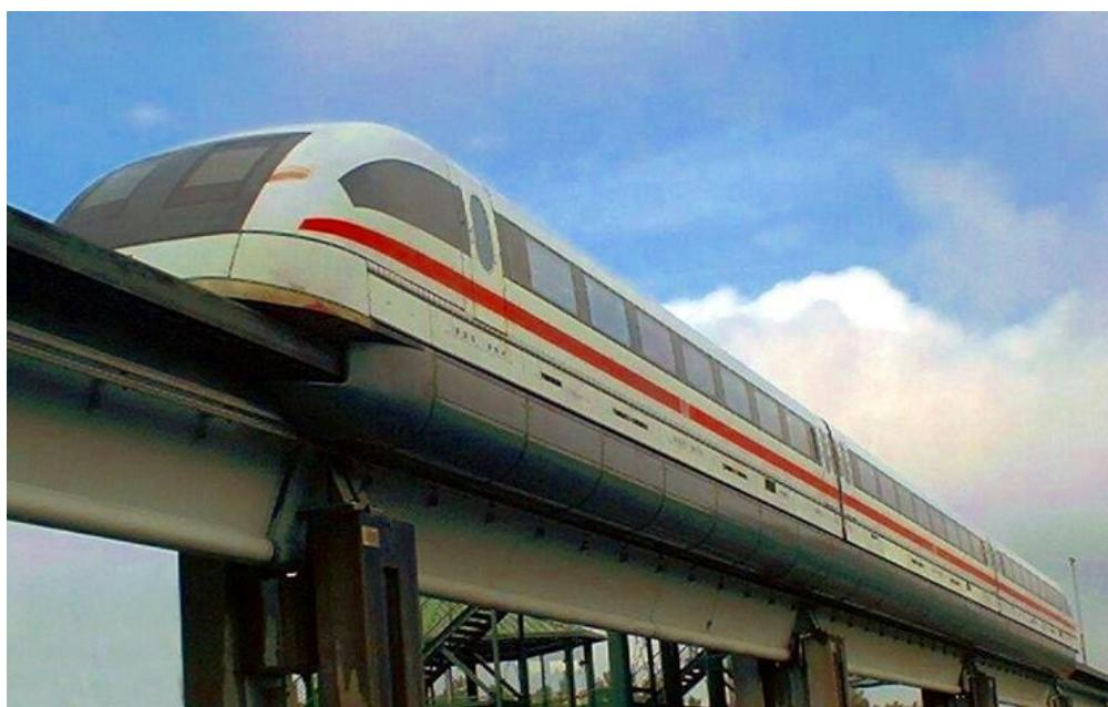
Sl. 18 Transrapid, njemačka verzija magnetno-levitacijskog vlaka [21]
