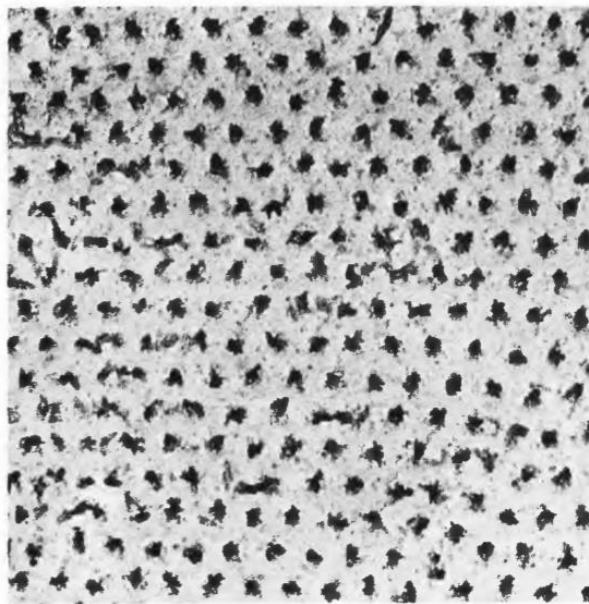
Sl. 9 Magnetski vrtlozi na površini supravodiča opaženi feromagnetskom prašinom (povećanje 8300 puta) [7]
