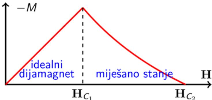
Sl. 7 Prikaz kad supravodič, supravodljiv i idealan dijamagnet, prelazi u miješano stanje ("vortex state") [5]
