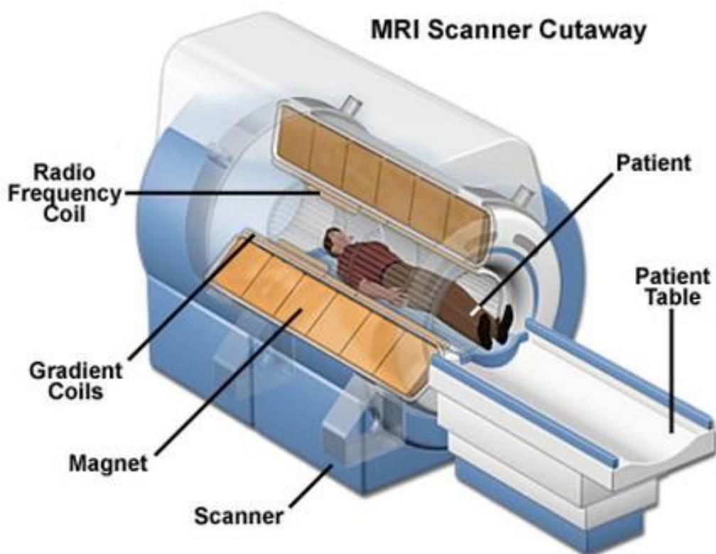
Sl. 19 Presjek uređaja za magnetsku rezonanciju [23]
