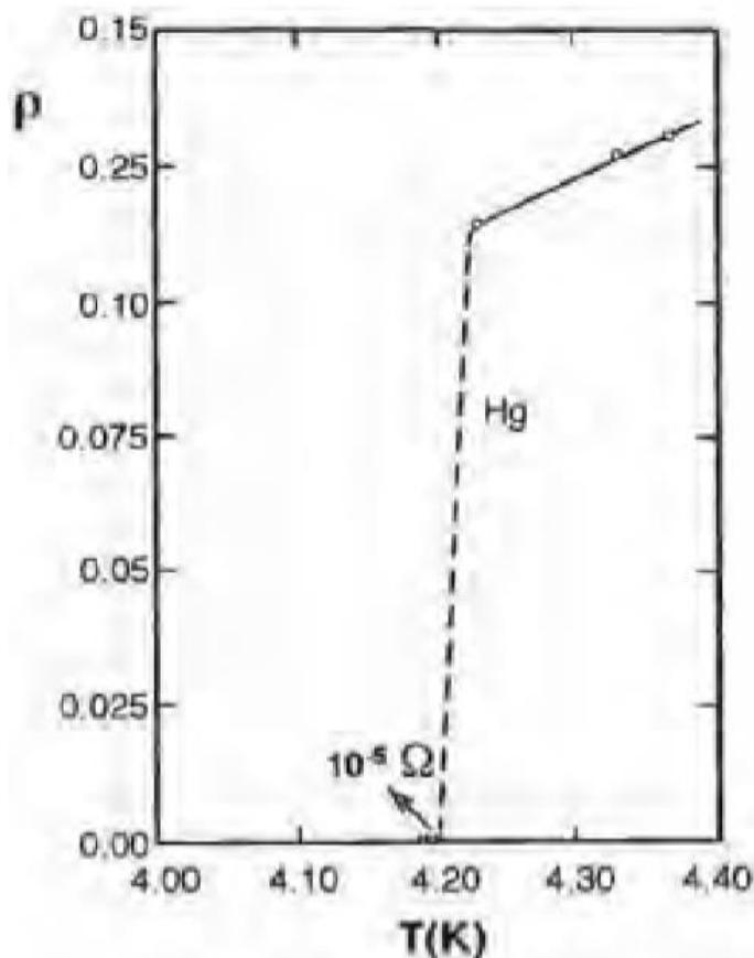
Sl. 1 Ilustracija Kamerlingh Onnesova otkrića supravodljivosti i nestajanje električnog otpora 1911. Godine [1]
