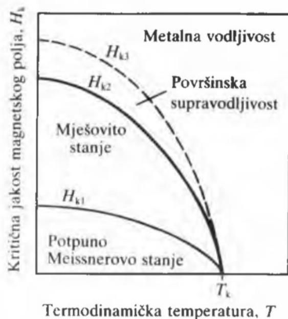
Sl. 10 Ovisnost kritične jakosti magnetskog polja o termodinamičkoj temperaturi,  $H_{k1}$  je kritična jakost magnetskog polja za pojavu Meissnerova stanja,  $H_{k2}$  za pojavu mješovitog stanja supravodljivosti te  $H_{k3}$  za pojavu površinske supravodljivosti [6]
