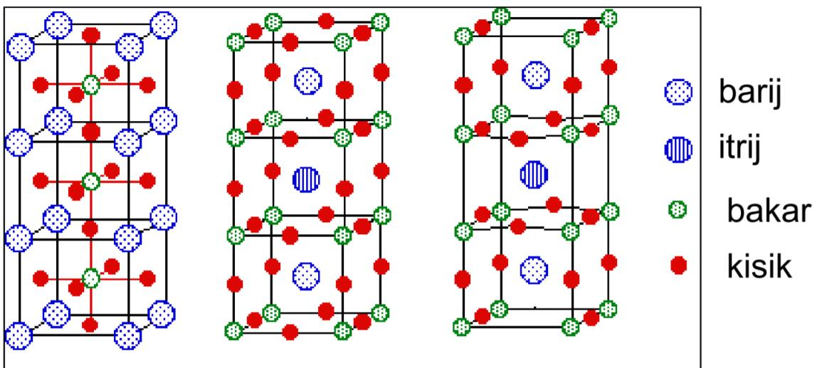
Sl. 11 Perovskita struktura, kubična rešetka na čijim vrhovima i u središtu nalaze se pozitivni metalni ioni [12]
