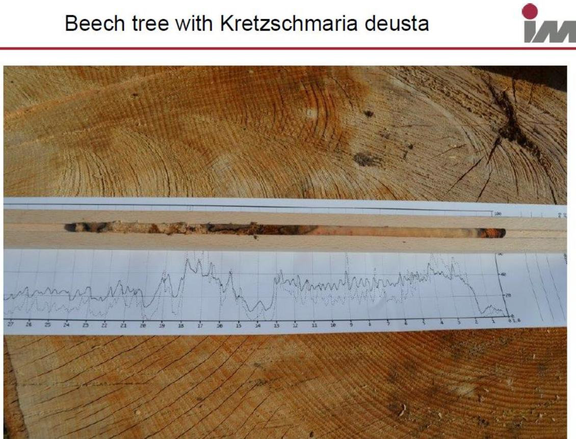
Slika 9. Usporedba izvata iz stabla, panja i print trake rezistrografa
