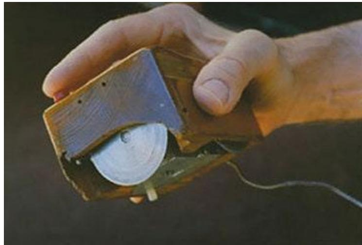
Slika 2: Prototip prvog računalnog miša [2]
