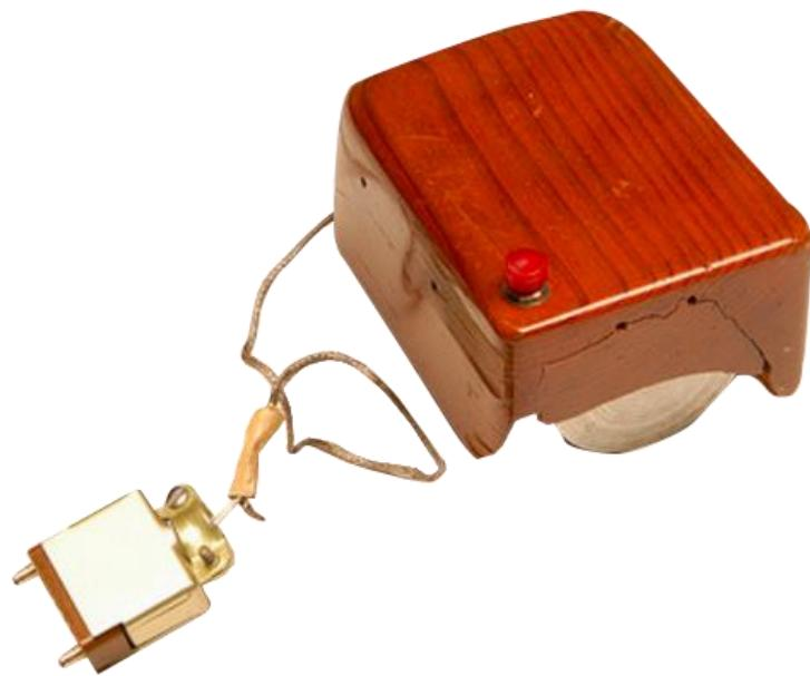
Slika 3: Prototip prvog računalnog miša [3]
