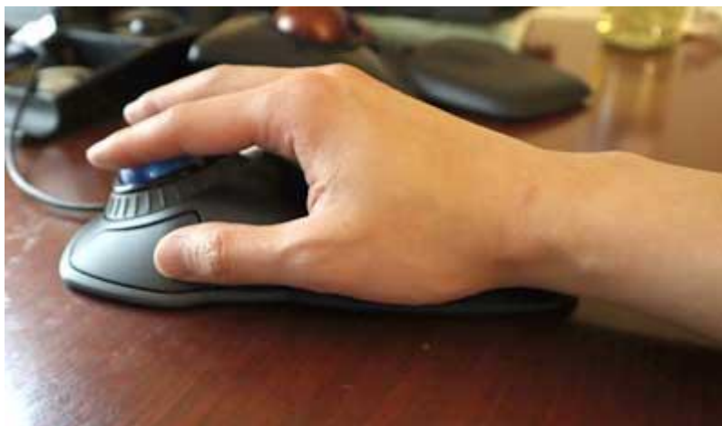
Slika 22: Trackball kojim se upravlja kažiprstom ili srednjim prstom [10]
