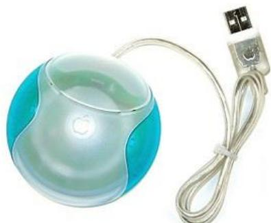
Slika 15: Appleov računalni miš s USB sučeljem [8]
