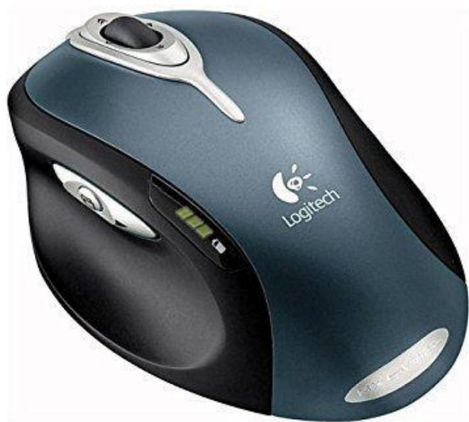
Slika 17: Prvi laserski računalni miš „Logitech MX 1000“ [9]
