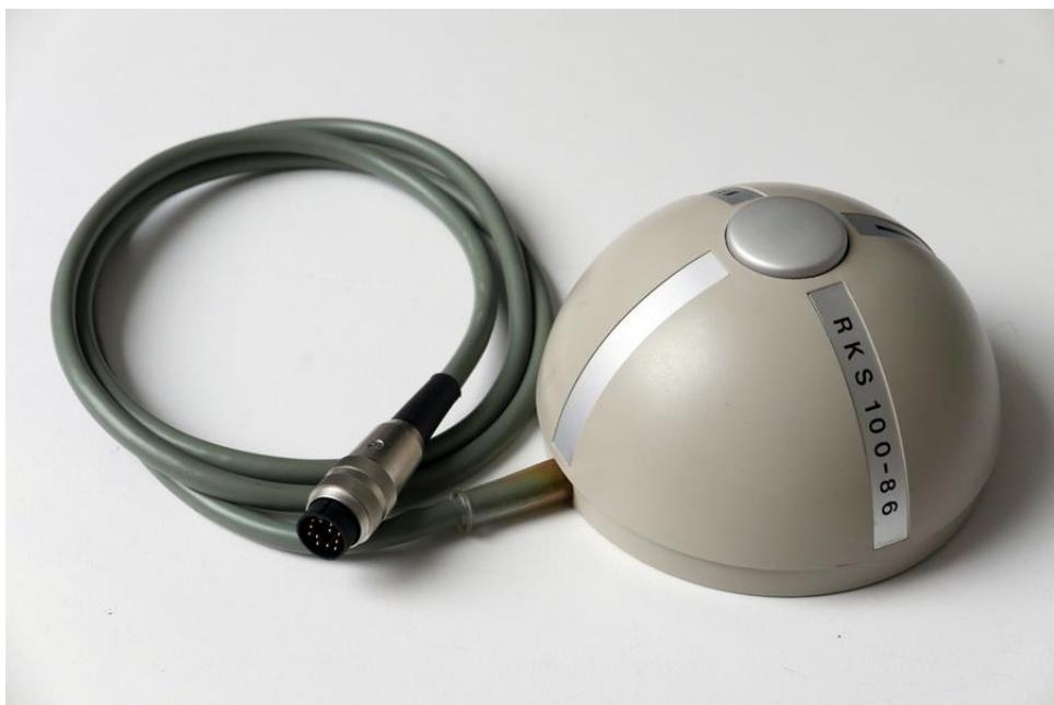
Slika 5: Rollkugel (od njem. kotrljajuća lopta) [4]
