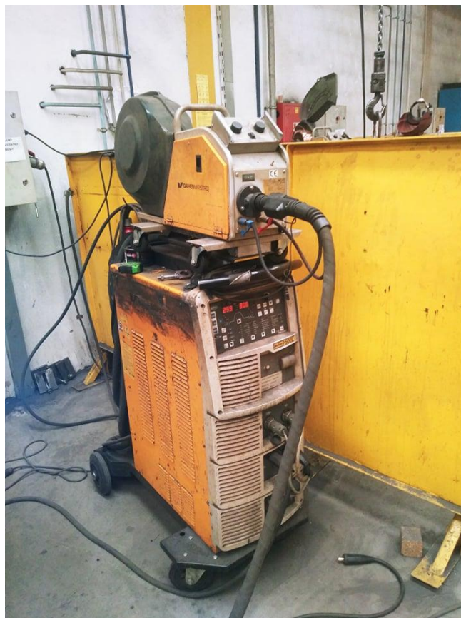
Slika 2: MIG/MAG aparat za zavarivanje [19]
