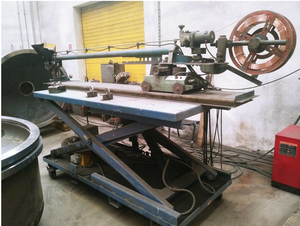
Slika 1: Aparat za elektrolučno zavarivanje pod zaštitom praška (EPP) [19]
