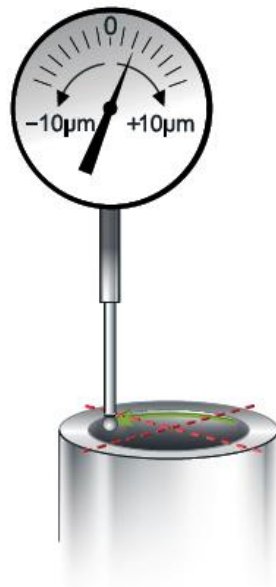
Slika 40. Ručno traženje centra kontrolnog prstena u ravnini X – Y uz pomoć mjerne ure – komparatora [23]
