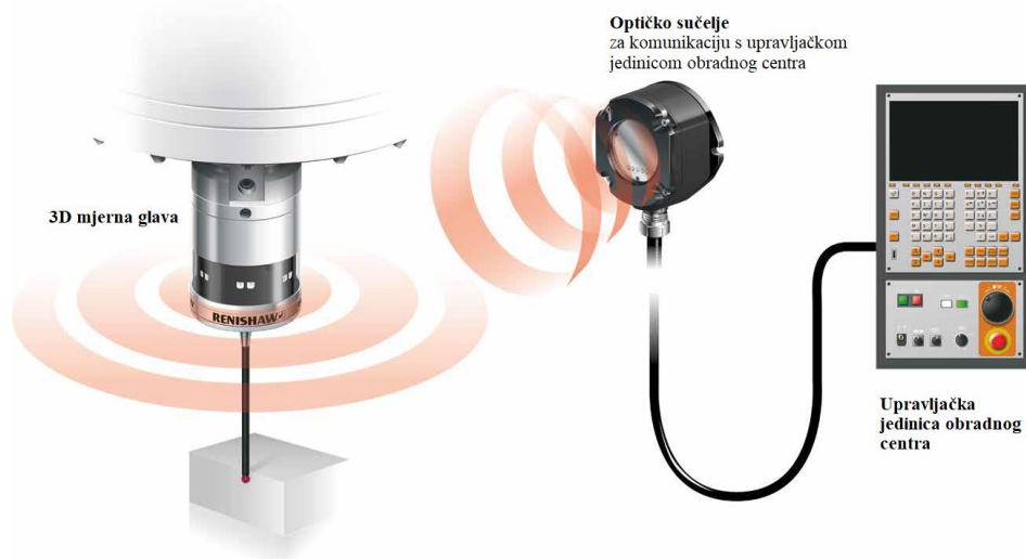
Slika 16. Optički sustav za prijenos podataka [16]
