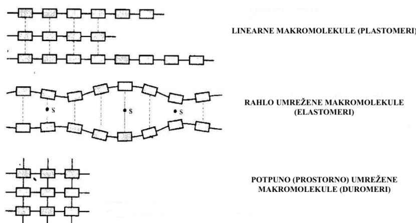
Slika 2. Shematska struktura osnovnih skupina polimera [6]
