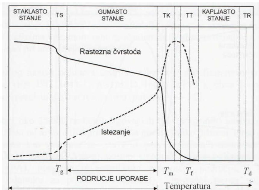
Slika 5. Temperaturna ovisnost mehaničkih svojstava kristalastih plastomera
