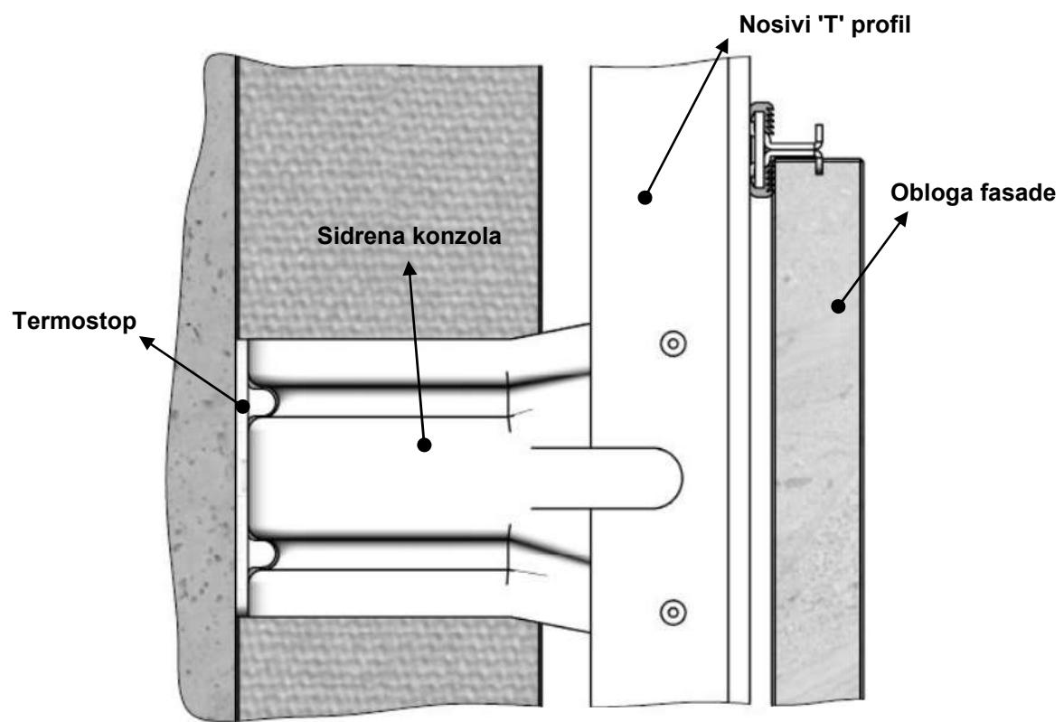
Slika 27. Prikaz detalja podkonstrukcije ventilirane fasade
