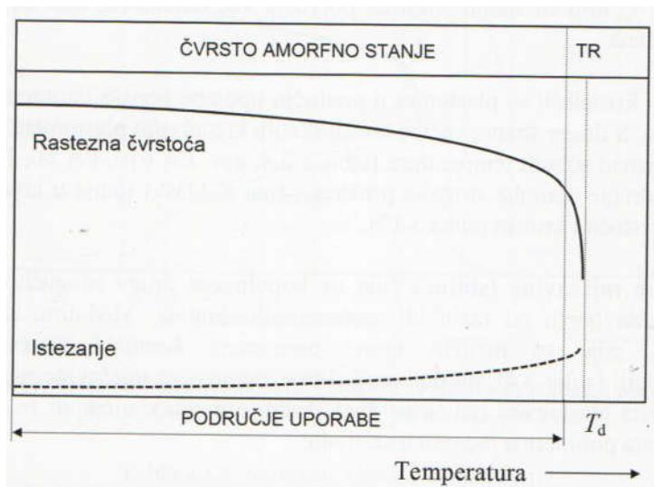
Slika 6. Tehnička ovisnost mehaničkih svojstava duromera [3]
