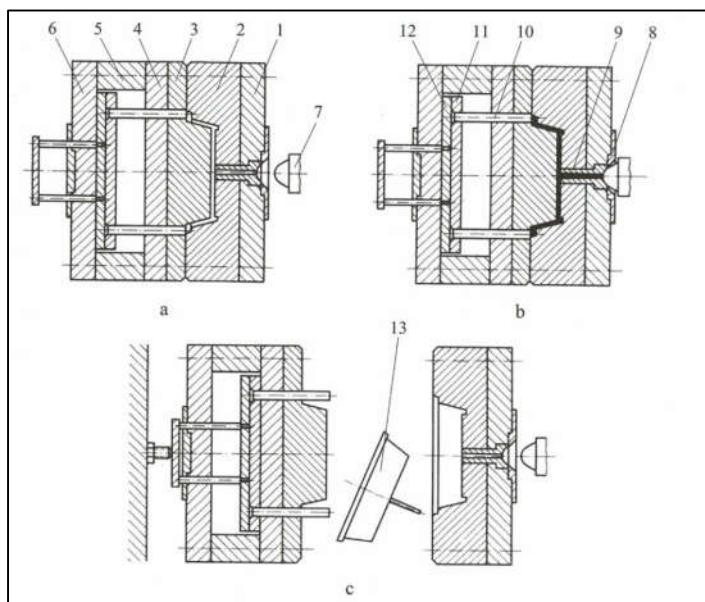
Slika 20. Kalup za injekcijsko prešanje plastomera [2]
