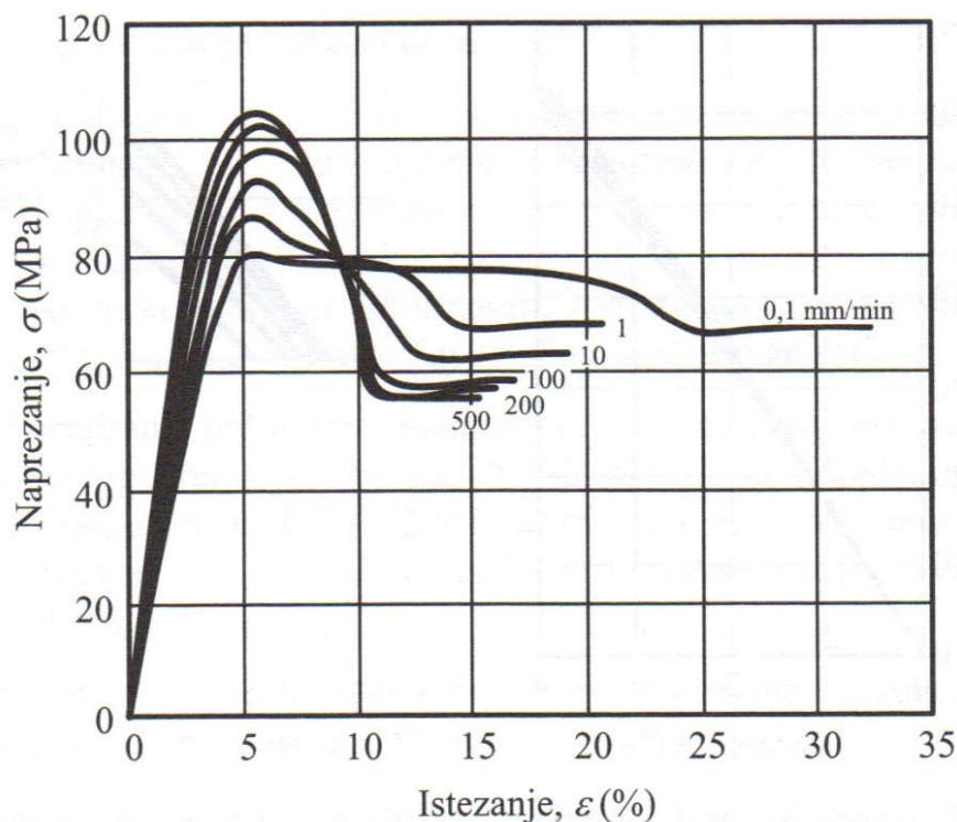
Slika 15. Utjecaj brzine deformiranja suhog poliamida (PA 66) na oblik  $\sigma$ - $\varepsilon$  krivulja [2]
