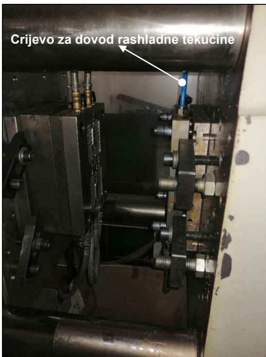
Slika 35. Prikaz otvorenog alata
