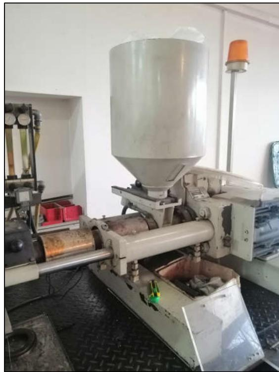
Slika 32. Lijevak ekstrudera
