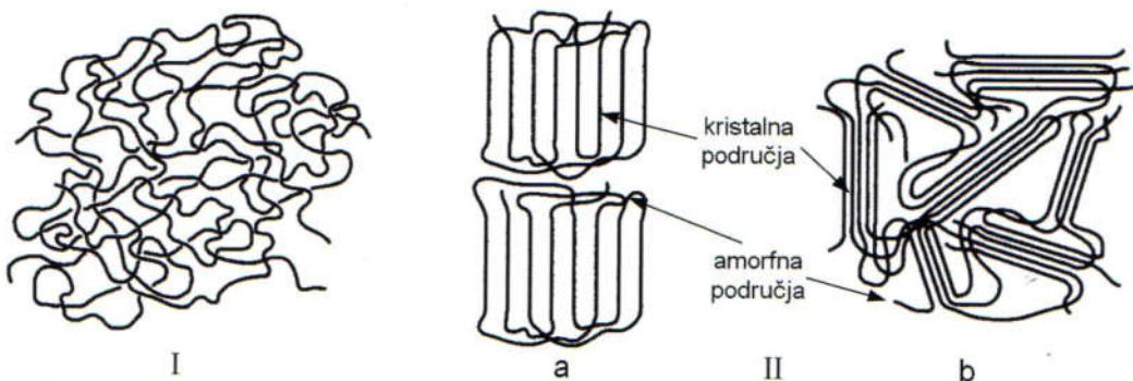
Slika 3. Nadmolekulna struktura polimera (I-amorfna, II-kristalasta, a-savijeno kristalizirane lemele, b-usporedno kristalizirane lamele) [3]
