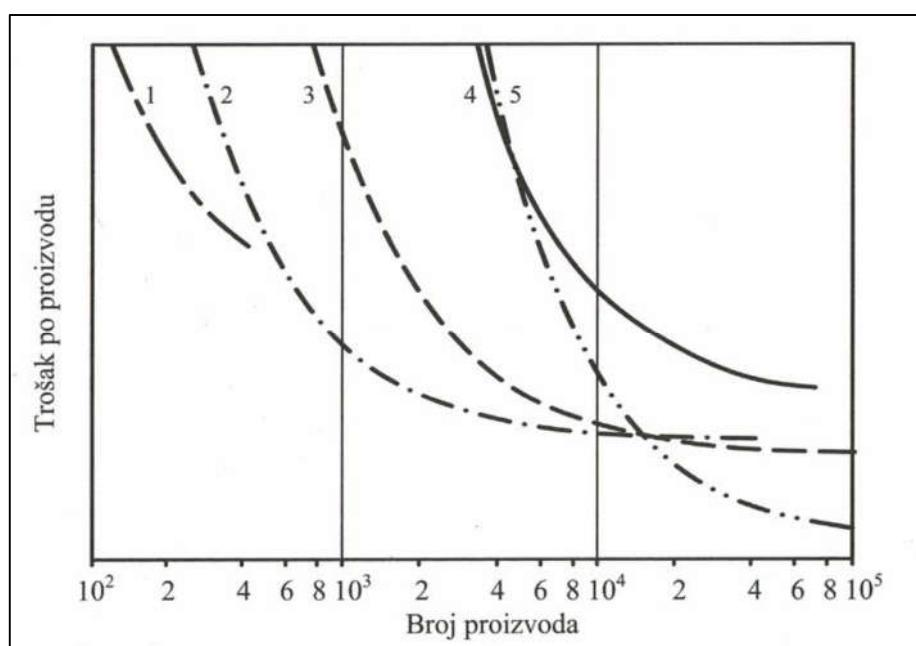
Slika 19. Ovisnost cijene proizvoda o proizvodnim količinama i vrsti proizvodnog postupka:
