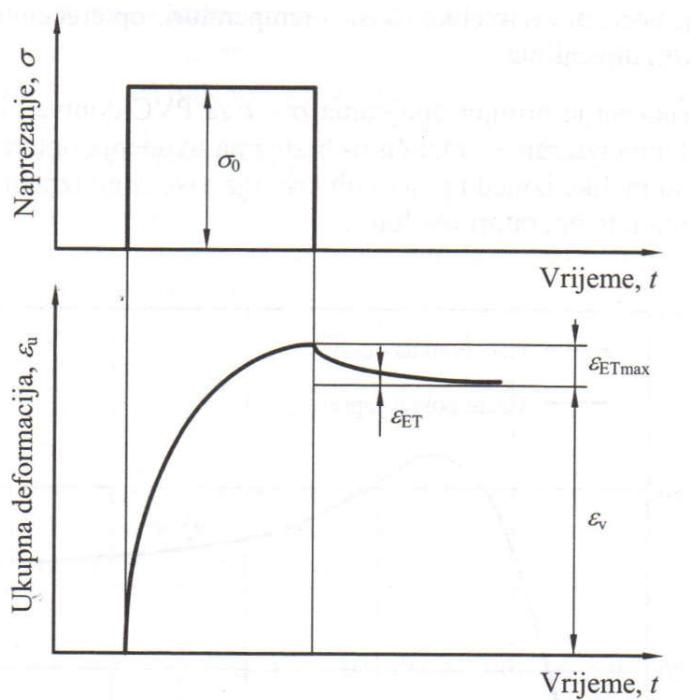
Slika 10. Deformacija (istezanje) pri opterećivanju i rasterećenju polimernog konstrukcijskog elementa [2]
