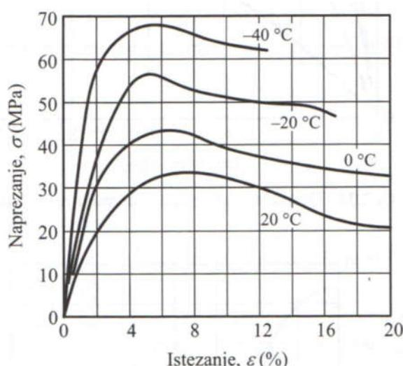
Slika 24. Ovisnost naprezanja o istezanju [2]
