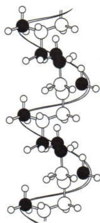
Slika 23. Vijčana konformacija izotaktnog polipropilena[1]
