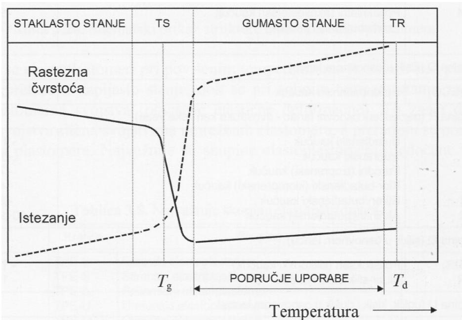
Slika 7. Temperaturna ovisnost mehaničkih svojstava umreženih elastomera [3]
