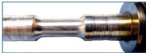
Oštećenje ležajnih mjesta uslijed tvrdih čestica u ulju
