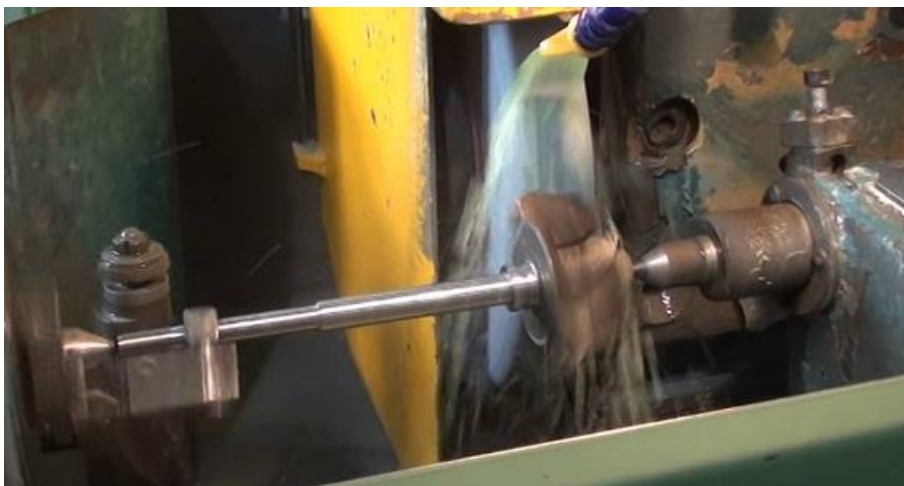
Slika 18 Brušenje turbinskog rotora [12]
