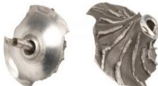
Pucanje komp. rotora uslijed prevelike brzine vrtnje
