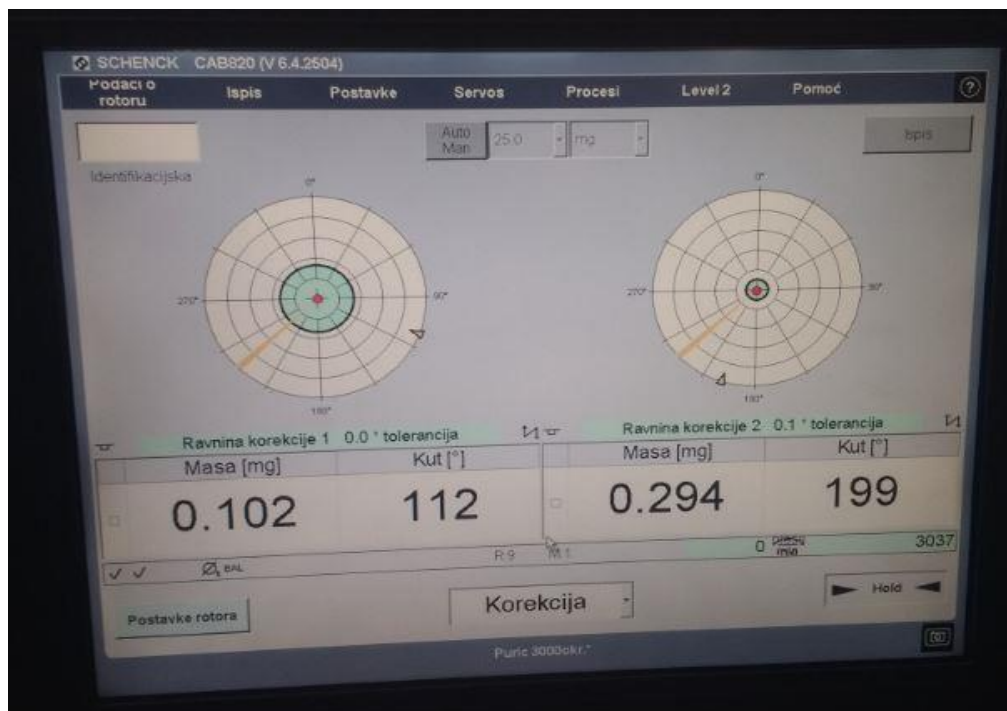
Slika 53 Finalni rezultat 1. balansiranja [17]
