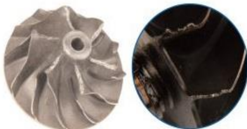
Oštećenja uslijed prolaza stranog tijela preko rotora
