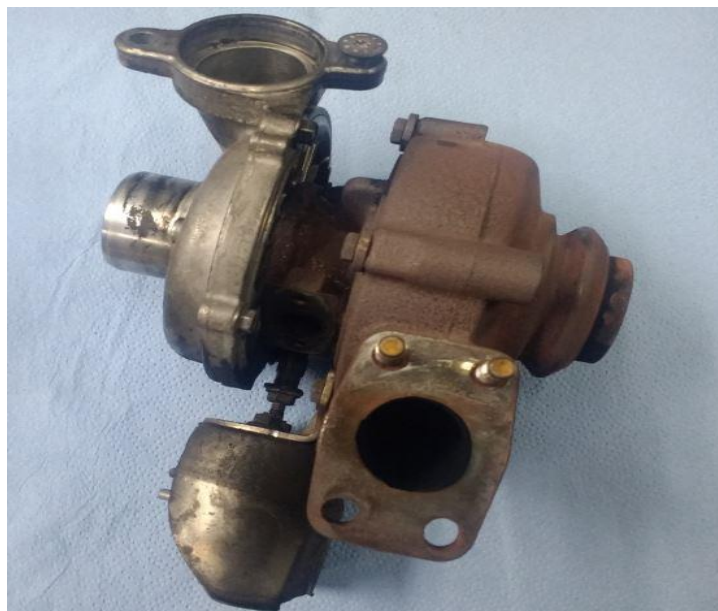
Slika 35 Neispravan sklop – turbopunjač [17]
