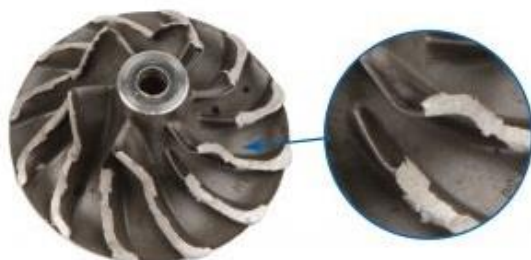
Oštećena ležajna mjesta/manjak podmazivanja/prevelika brzina vrtnje
