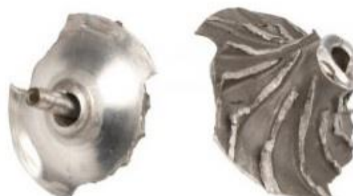
Pucanje komp. rotora uslijed prevelike brzine vrtnje
