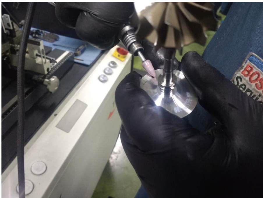
Slika 51 Uklanjanje mase - kompresijski rotor [17]
