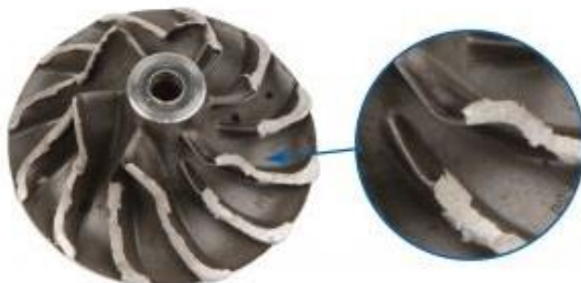
Oštećena ležajna mjesta/manjak podmazivanja/prevelika brzina vrtnje
