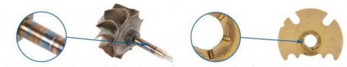
Pregrijavanje/zaribavanje uslijed manjka tlaka ulja
