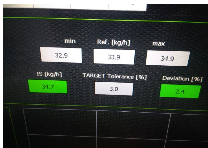
Slika 62 Podešenje protoka varijabilne geometrije [17]
