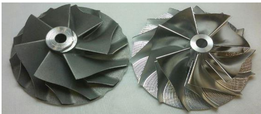
Slika 20 Lijevani te kovano/glodani kompresijski rotor [14]
