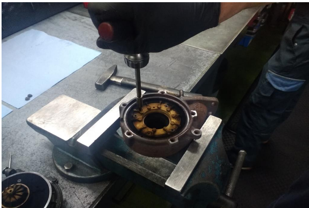
Slika 39 Rastavljanje varijabilne geometrije unutar turbinskog kućišta [17]
