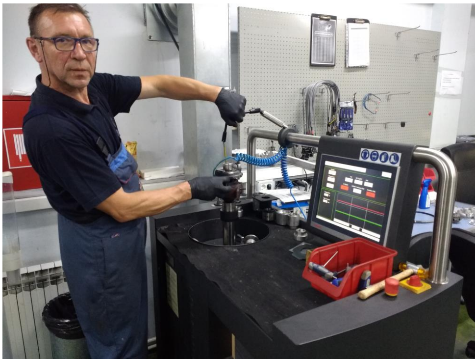
Slika 38 Mjerenje protoka varijabilne geometrije [17]
