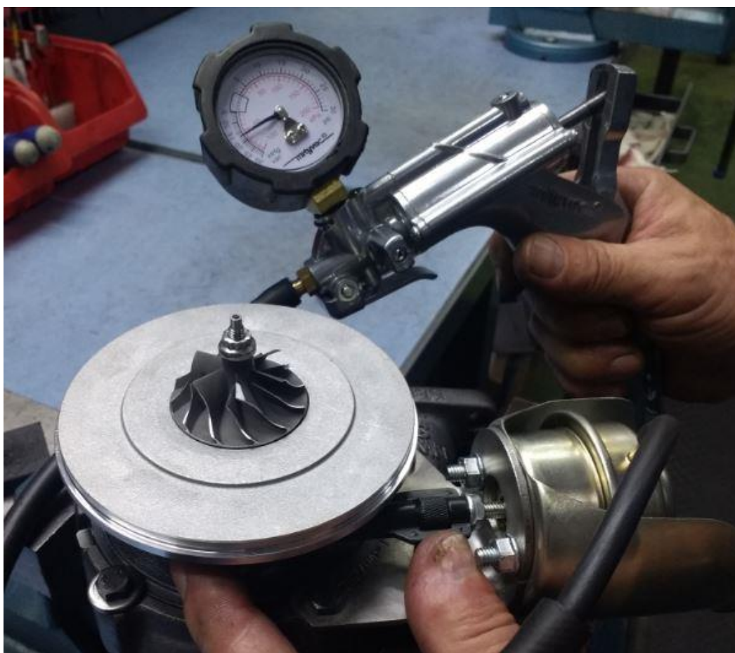
Slika 64 Podešavanje vakuumskog akuatora [17]
