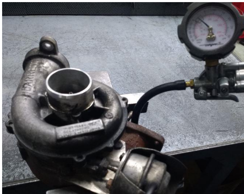
Slika 37 Vakuumska provjera podešenja aktuatora [17]
