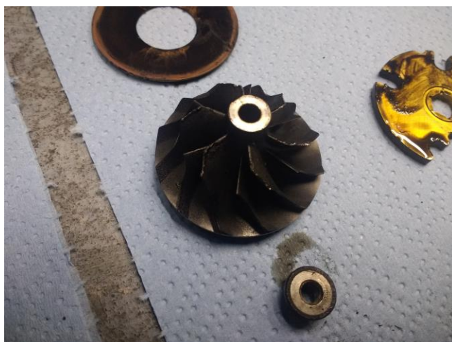
Slika 43 Oštećen kompresijski rotor [17]
