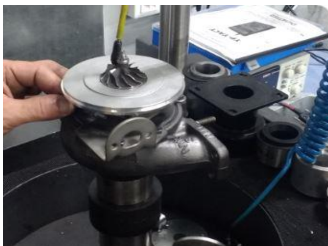
Slika 62 Podešenje protoka varijabilne geometrije [17]
