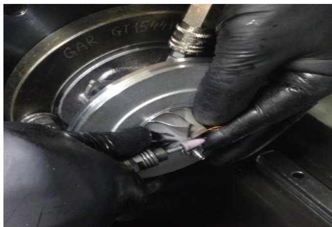
Slika 59 Uklanjanje viška mase na matici kompresijskog rotora [17]
