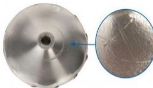
Narančina kora na poleđini kompresijskog rotora - prevelika brzina vrtnje
