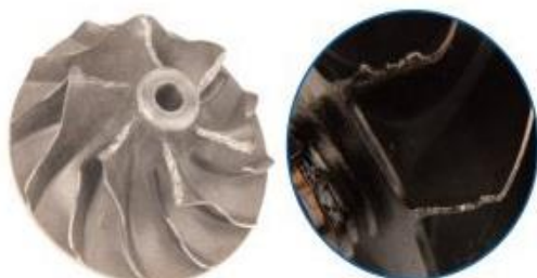
Oštećenja uslijed prolaza stranog tijela preko rotora
