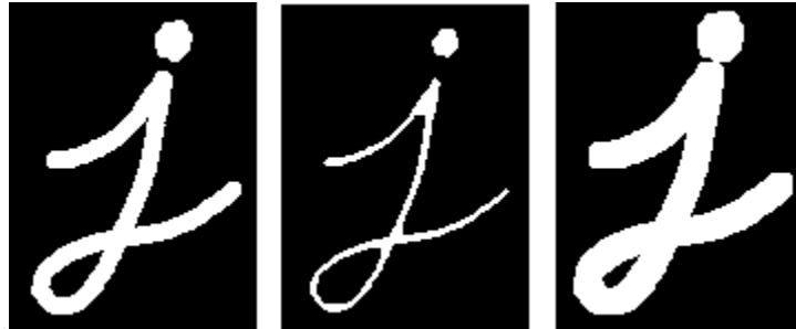
Slika 27: Primjer funkcija erode() i dilate() [30]
