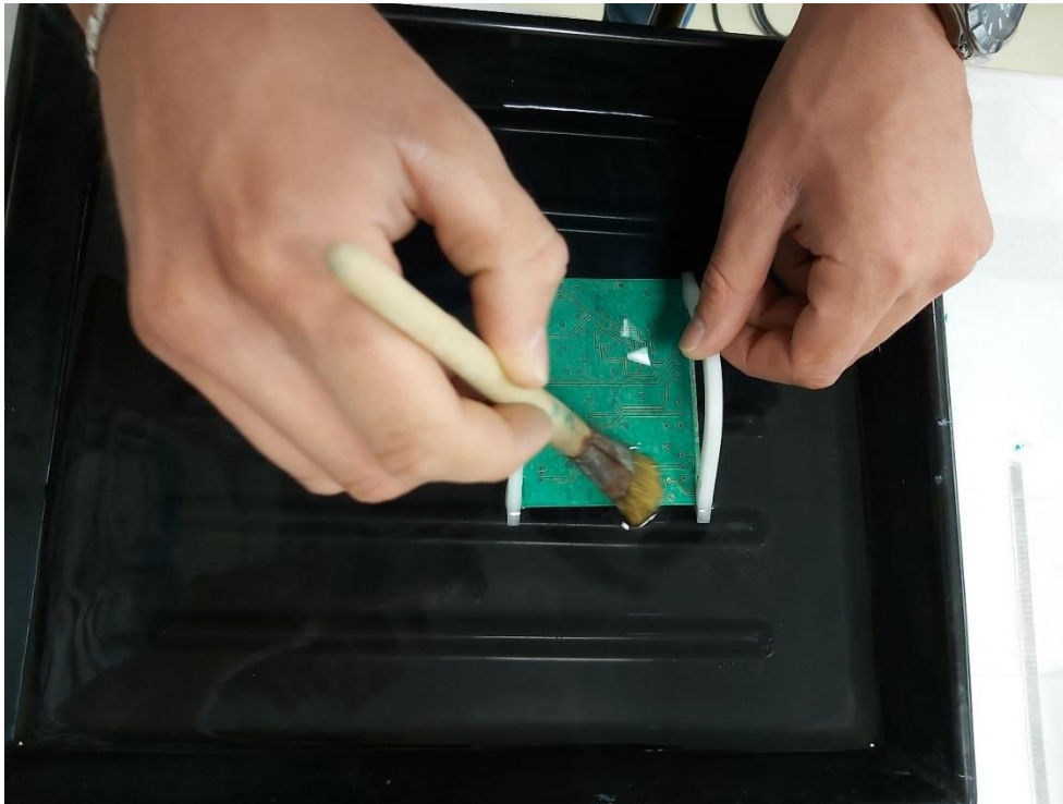
Slika 63. Skidanje sloja maske za lemljenje sa lemnih točaka
