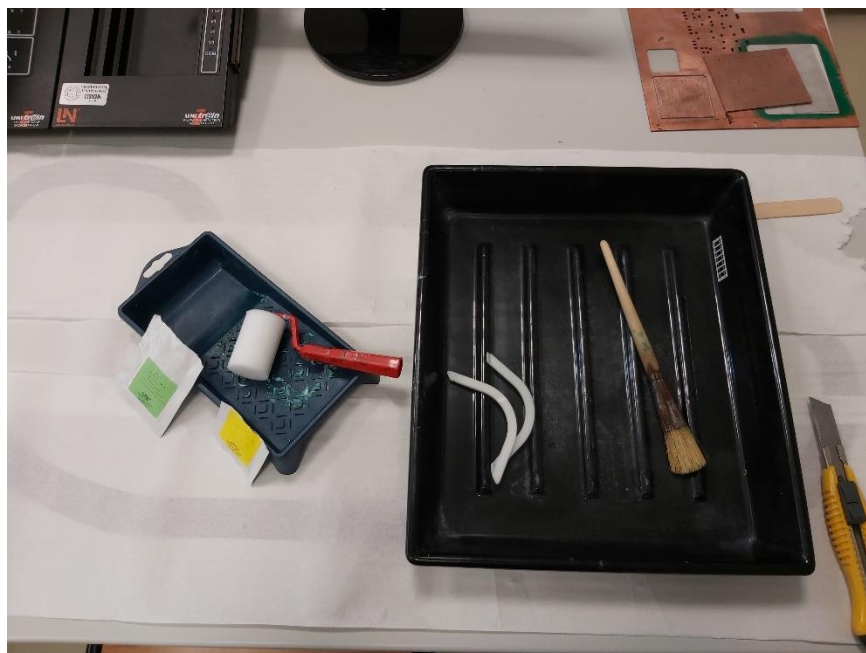
Slika 55. Pribor za stavljanje maske za lemljenje
