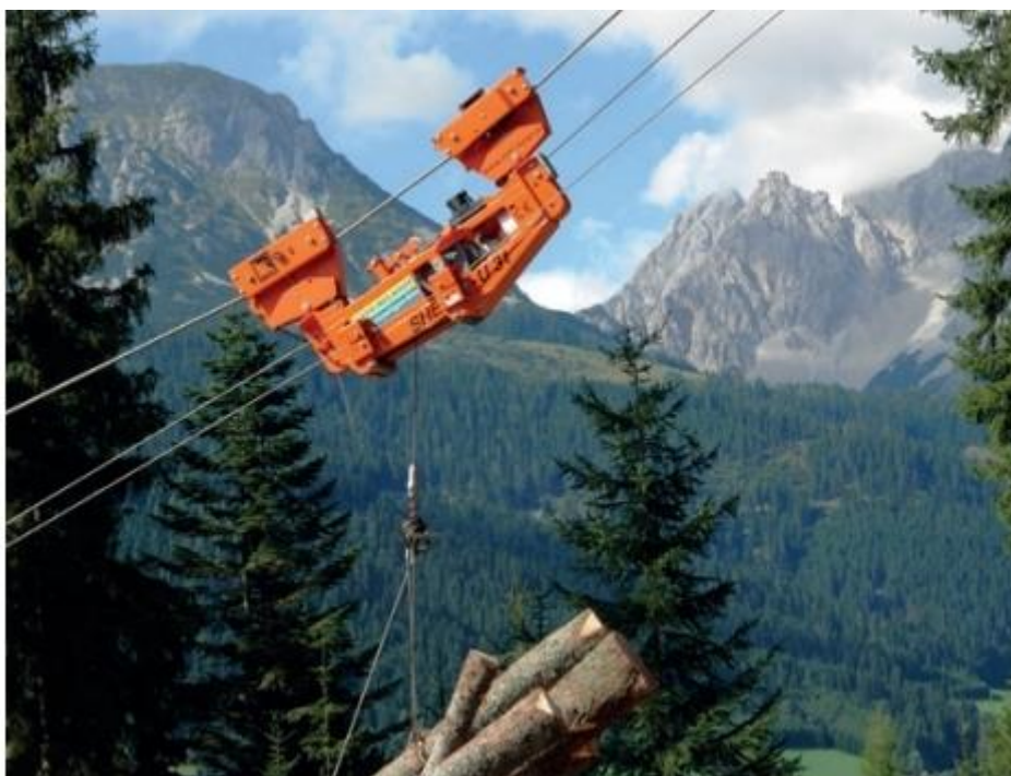
Slika 10: Zasebna kolica sa radio navođenjem i motorom za pokretanje [10]
