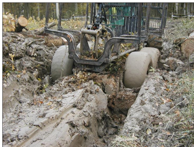
Slika 3: Oštećivanje tla uslijed pretovara [3]
