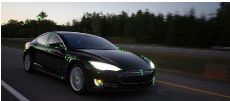
Slika 12 Shi-Tomasi detekcija kuteva
