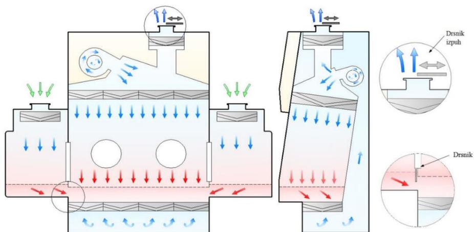
Slika 19. Prikaz strujanja zraka u izolatoru [13]
