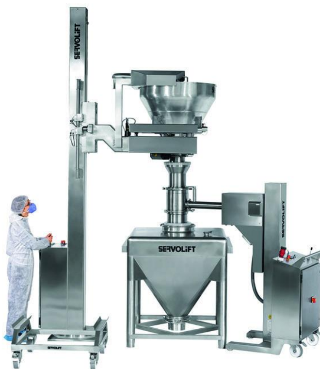
Slika 12. Mlin sa priključenim spremnicima spreman za proizvodnju [9]
