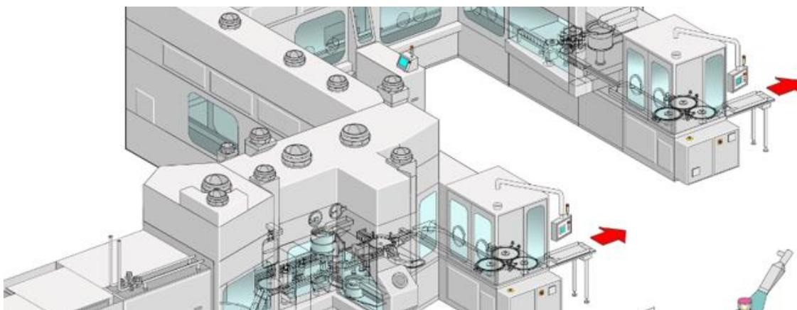
Slika 20. Primjer proizvodne linije u „containment“ izvedbi [14]
