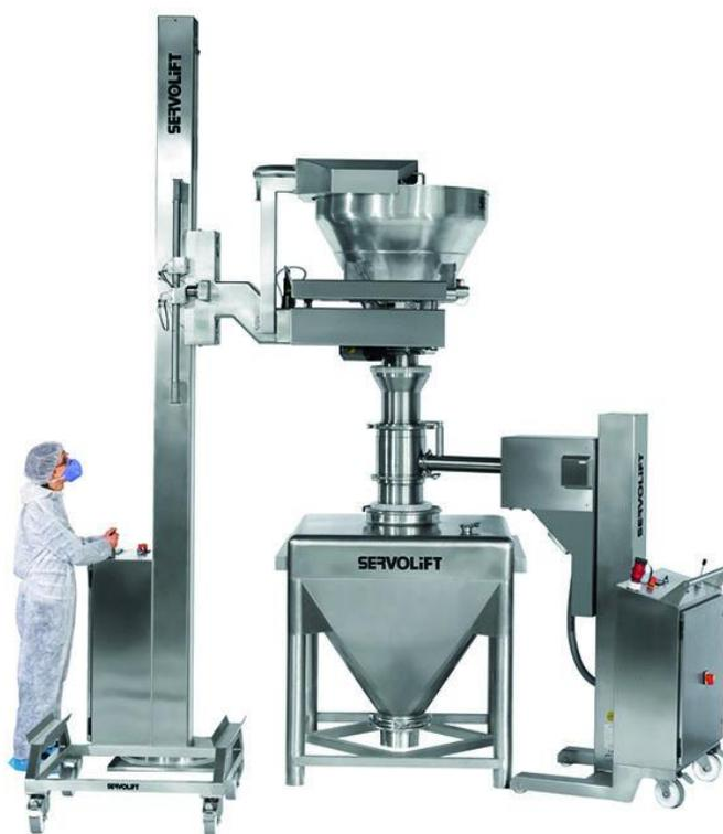
Slika 12. Mlin sa priključenim spremnicima spreman za proizvodnju [9]
