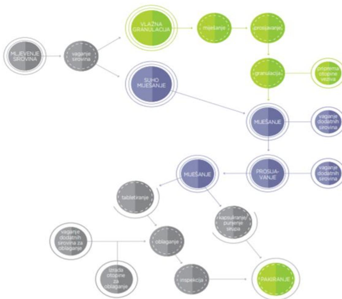
Slika 1. Prikazuje tijek osnovnih procesa u proizvodnji tableta i kapsula [1]
