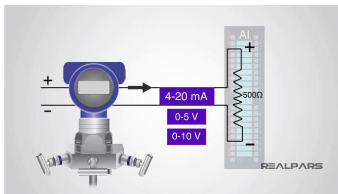
Slika 15. Princip rada mjerača diferencijalnog tlaka tlaka [12]
