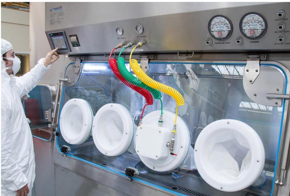
Slika 21. Prikaz testiranja nepropusnosti rukavica za rad operatera [15]
