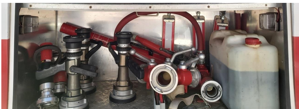
Sl.14. Međumješalica, mlaznice, pjenilo navalnog vatrogasnog vozila DVD Beretinec [9]
