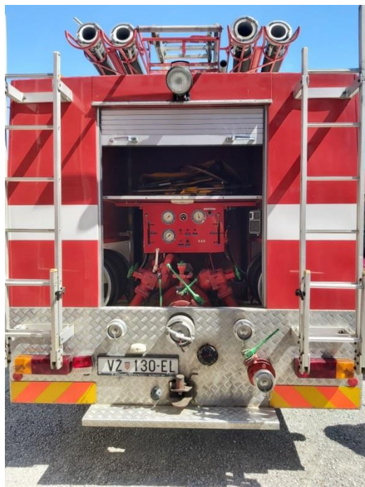
Sl.12. Vatrogasna pumpa, usisni vod, ljestve navalnog vatrogasnog vozila DVD Beretinec [9]
