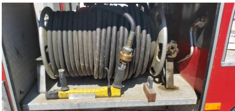
Sl.15. Vitlo i pištolj mlaznica navalnog vatrogasnog vozila DVD Beretincec [9]
