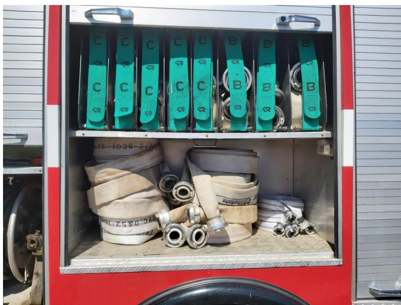
Sl.9. Cijevi navalnog vatrogasnog vozila DVD Beretinec [9]
