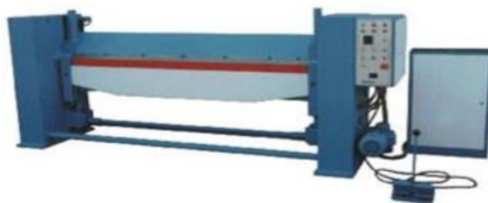
Slika 31. Valjak za obradu lima s fotoćelijama[2]
