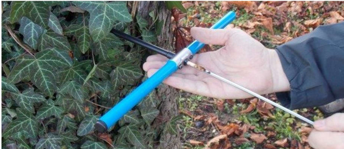
Slika br. 20 Uzimanje uzorka Pressler-ovim svrdlom (divlji kesten - stablo br.7)
