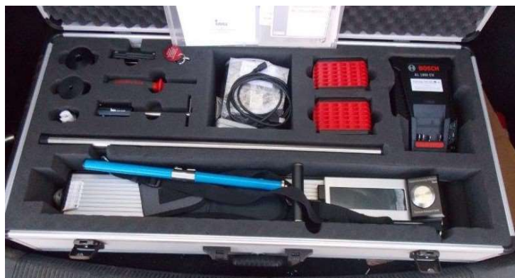
Slika br. 4 Rezistograf IML - RESI PD 400
