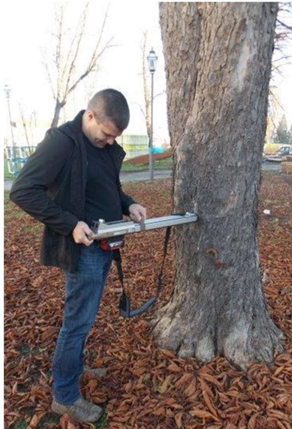
Slika br. 8 Rezistograf daje uvid u stanje debla stabla
