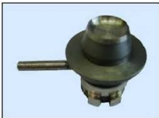
Slika 10: Dno pred kalupa. [2]
