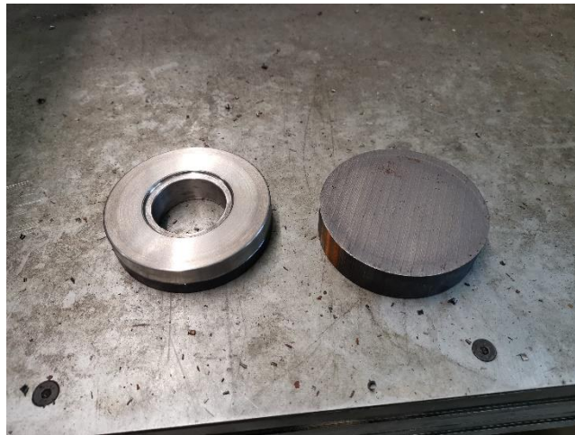
Slika 43: Tokarenje prstena do metalizacije.
