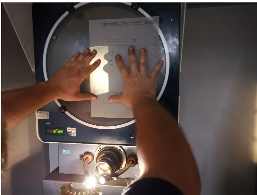
Slika 59: Kontrola grla na projektoru.
