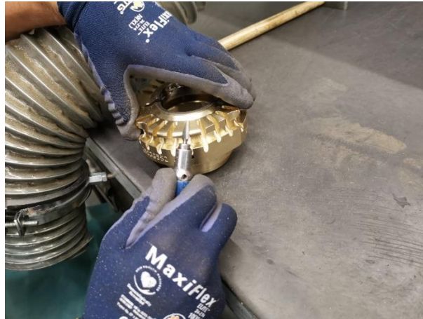
Slika 41: Skidanje oštrih rubova i dorada navoja.
