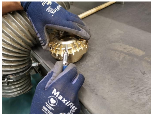
Slika 41: Skidanje oštrih rubova i dorada navoja.
