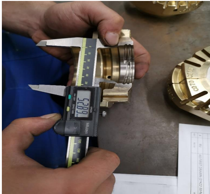
Slika 56: Kontrola promjera fazone pomičnim mikrometrom.
