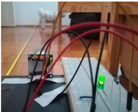
Slika 24. Predodžba reagiranja PIR senzora na visini: a) 0,2m; b) 0,5 m [Izvorno autor]
