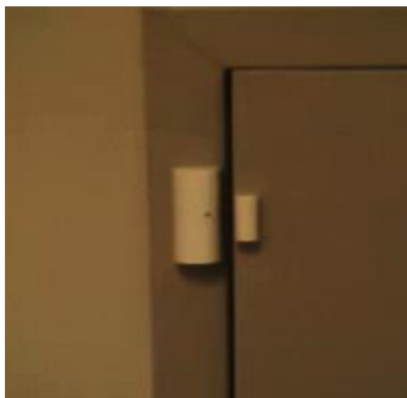
Slika 5. Predodžba bežičnog magnetskog prekidača na vratima. [7]
