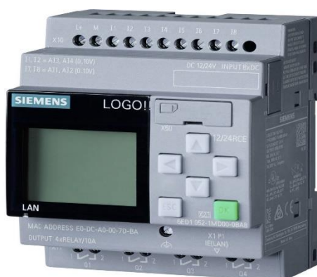
Slika 16. Predodžba Siemens-ovog PLC-a.
