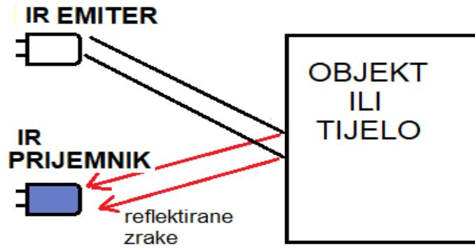
Slika 10. Predodžba rada aktivnog infracrvenog senzora refleksije.
