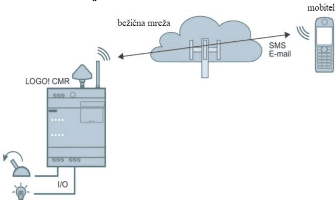
Slika 19. Predodžba bežičnog povezivanja komunikacijskog modula i mobitela. [26]
