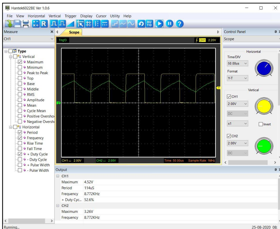
Slika 49: Mjerenje frekvencije korištenjem digitalnog osciloskopa
