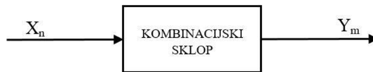
Slika 24: Blok-shema kombinajskog sklopa
