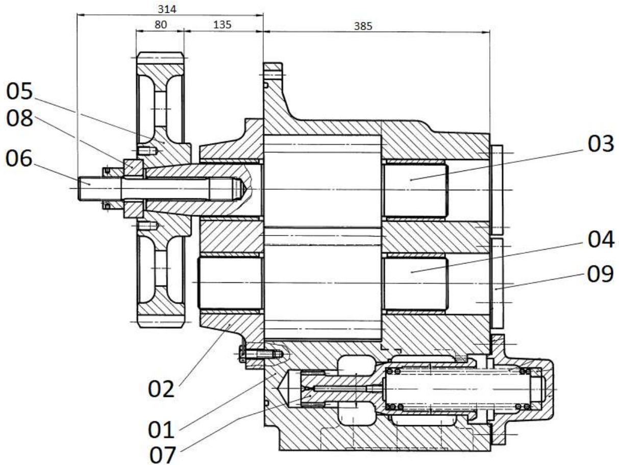
Slika 32. Presjek prigradene zupčaste pumpe ulja [4]
