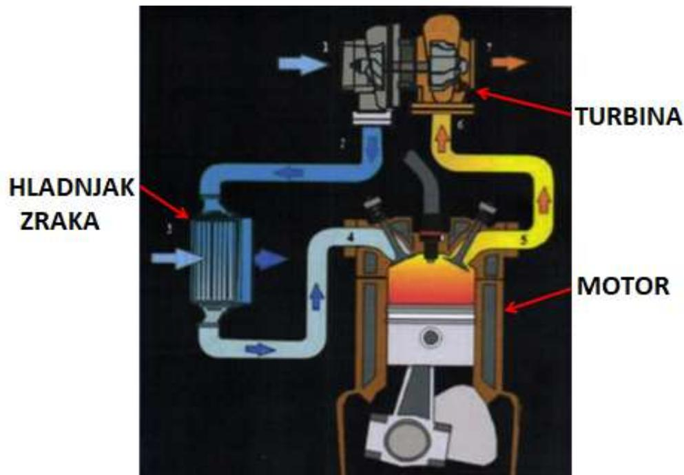
Slika 3. Shema rada VTR turbine i četverotaktnog motora [2]
