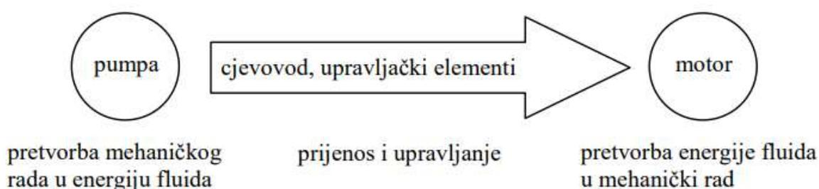
**Slika 22. Energetska pretvorba u hidrauličkom sustavu [6]**
