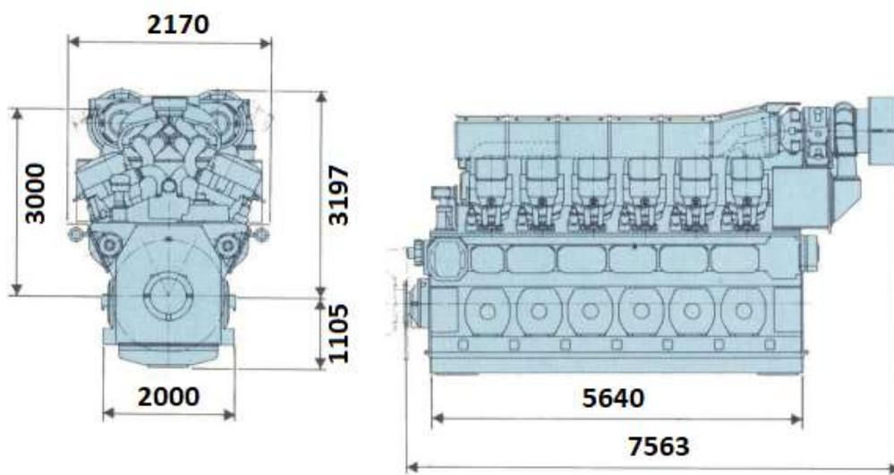
Slika 2. Gabaritne dimenzije pomoćnog stacionarnog motora [2]
