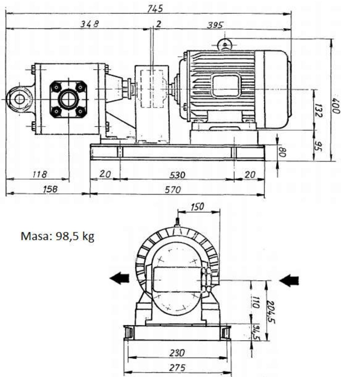
Slika 27. Skica pumpe agregata za predpodmazivanje košuljica cilindra - 35.6200.00 [4]
