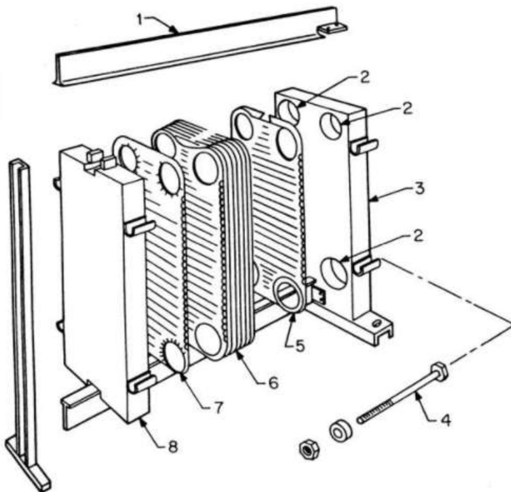
Slika 34. Osnovni dijelovi pločastog izmjenjivača topline [10]
