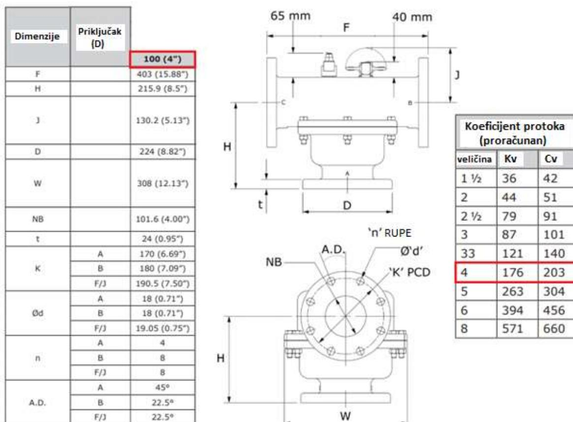
Slika 21. Kataloška specifikacija ventila 4BRDR model B [5]
