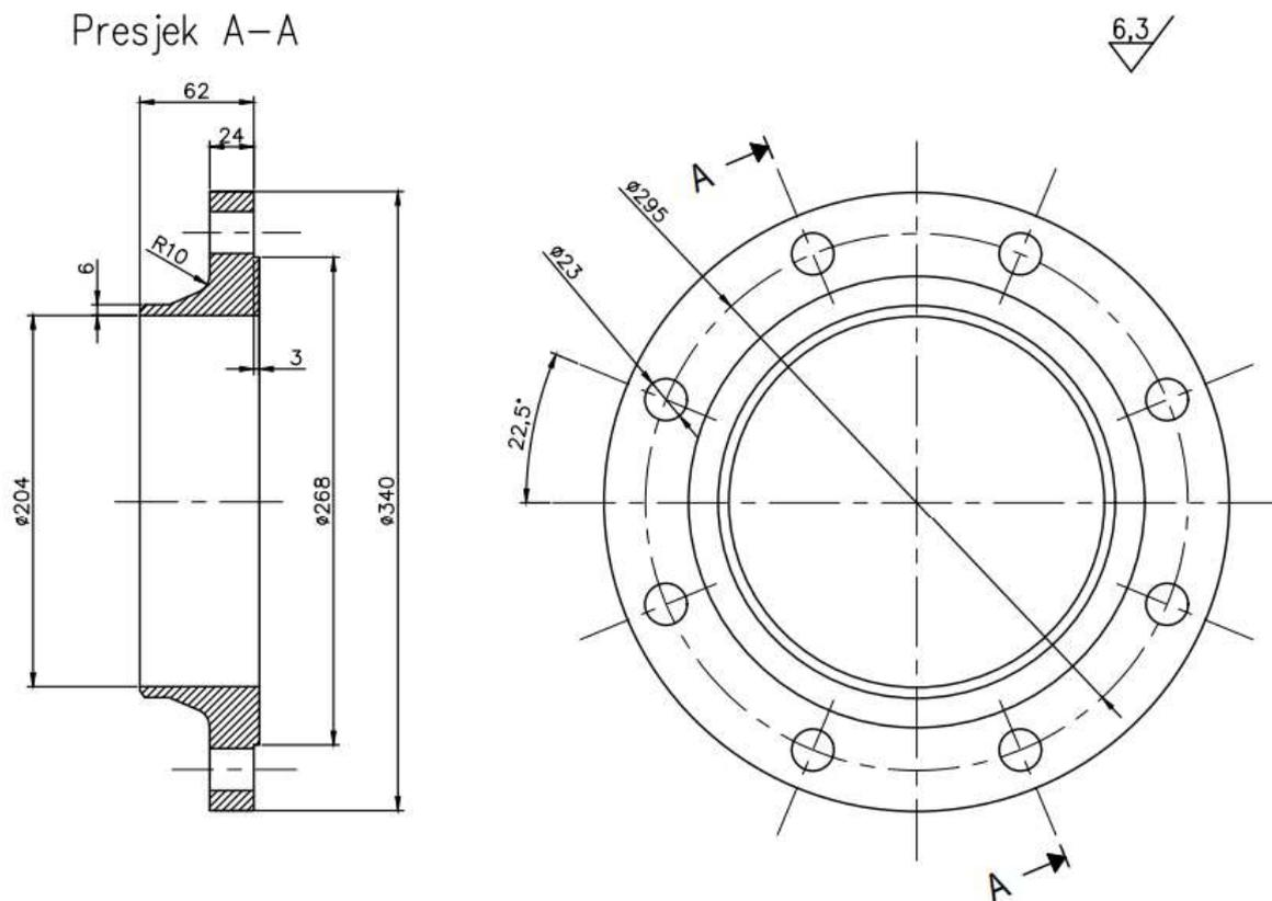
**Slika 46. Skica konstrukcije protuprirubnice filtra – 36.8450.30**
