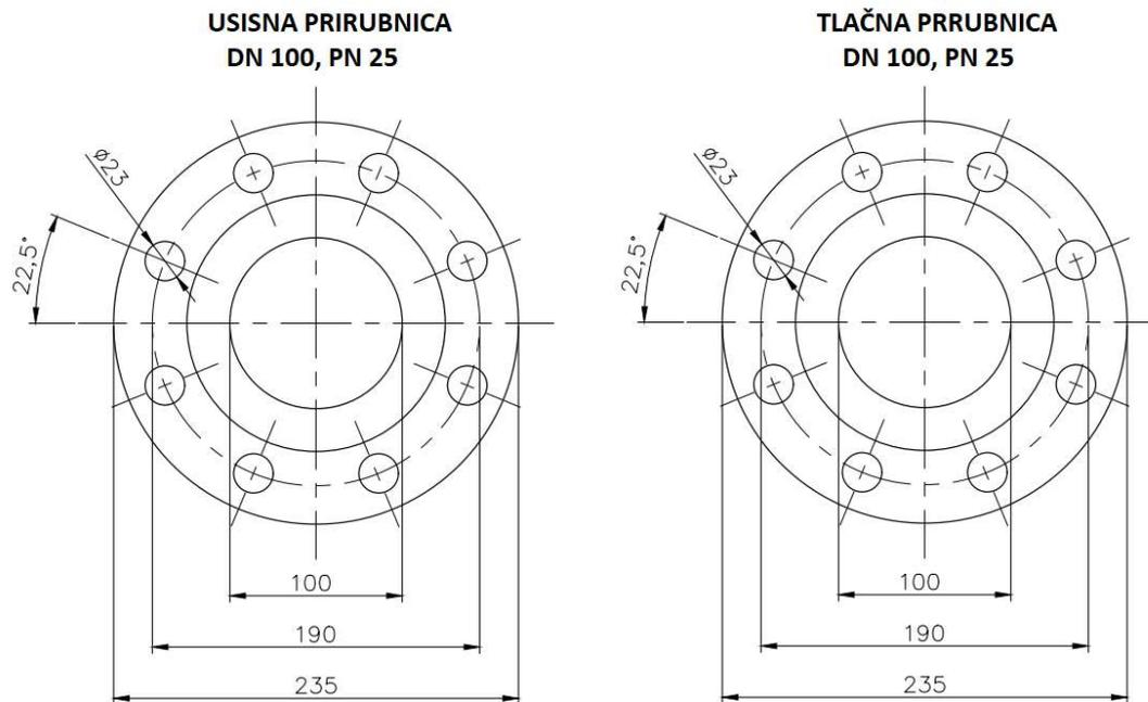
Slika 26. Usisna i tlačna prirubnica pumpe za predpodmazivanje
