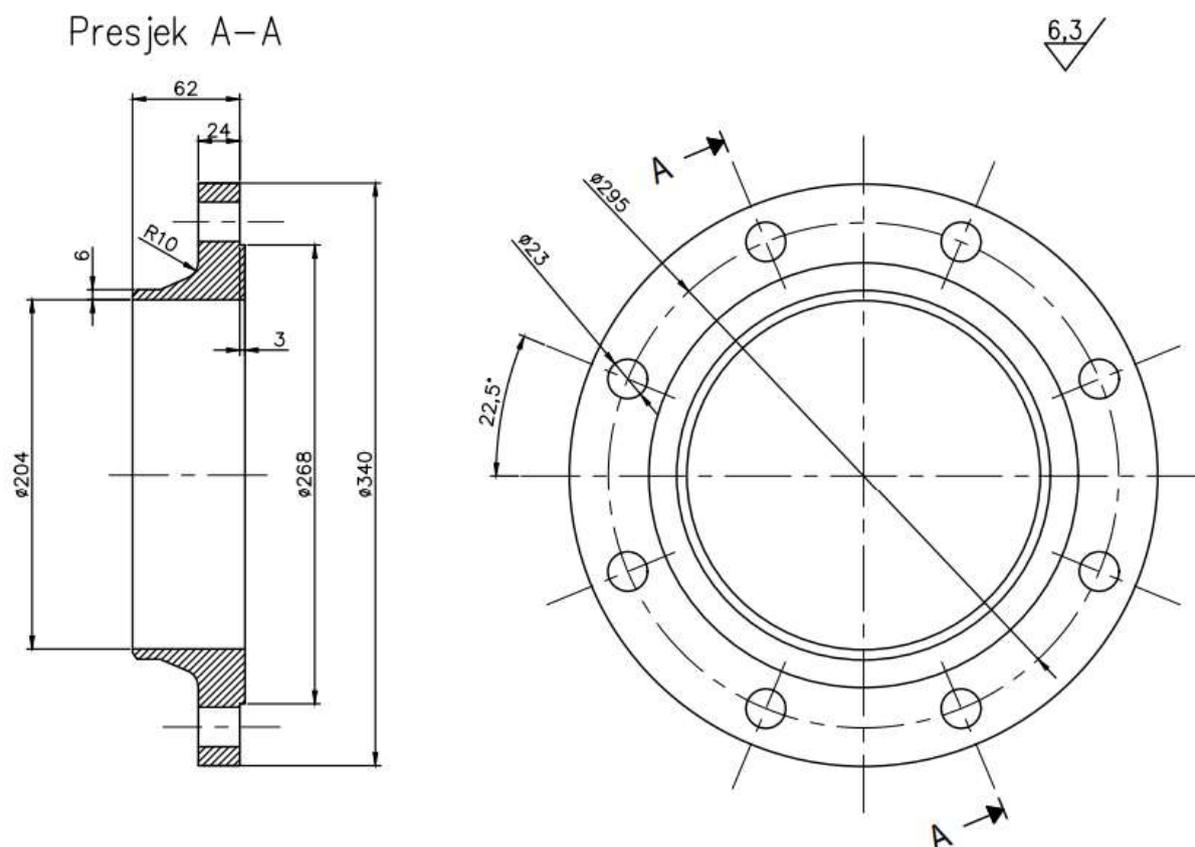
**Slika 44. Skica konstrukcije protuprirubnice filtra – 36.8450.40**
