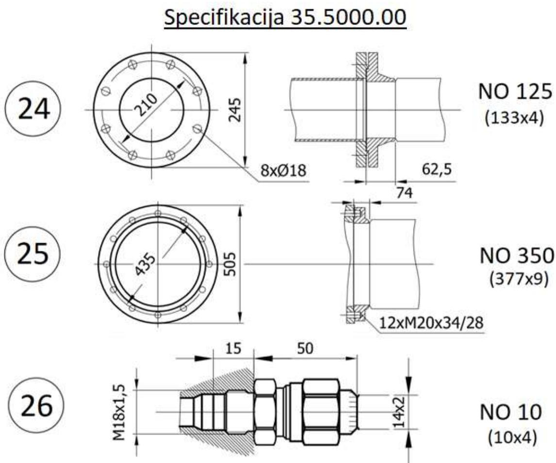
Slika 10. Specifikacija plana priključaka cjevovoda ulja na motoru [4]
