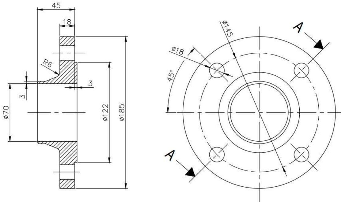
**Slika 48. Skica konstrukcije protuprirubnice filtra ulja – 36.8250.60**
