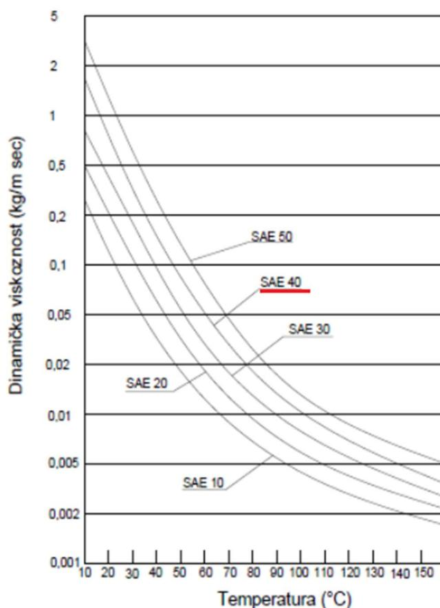
Slika 4. Karakteristika dinamičke viskoznosti i temperature ulja [3]
