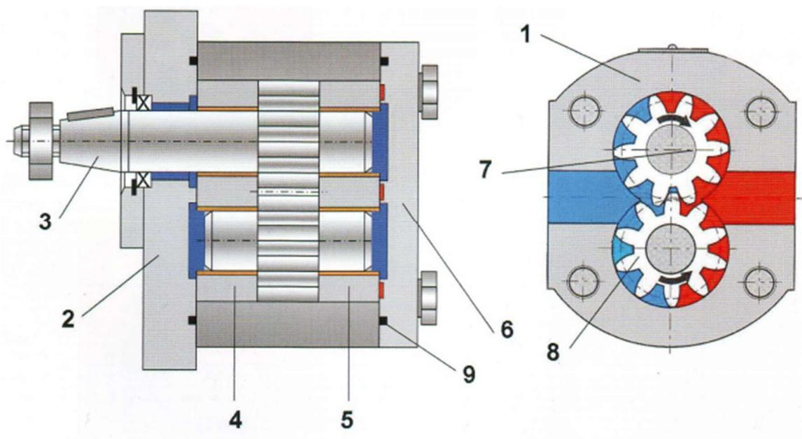
Slika 23. Zupčasta pumpa s vanjskim ozubljenjem [7]
