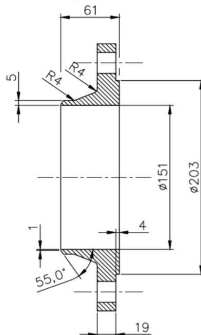
**Slika 17. Konstrukcija protuprirubnice – 37.1210.00**
