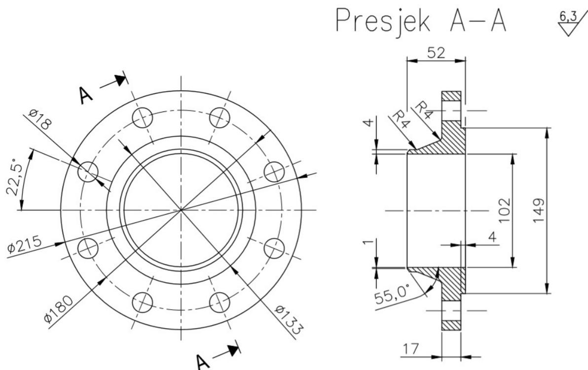
**Slika 19. Konstrukcija protuprirubnice – 37.1220.00**
