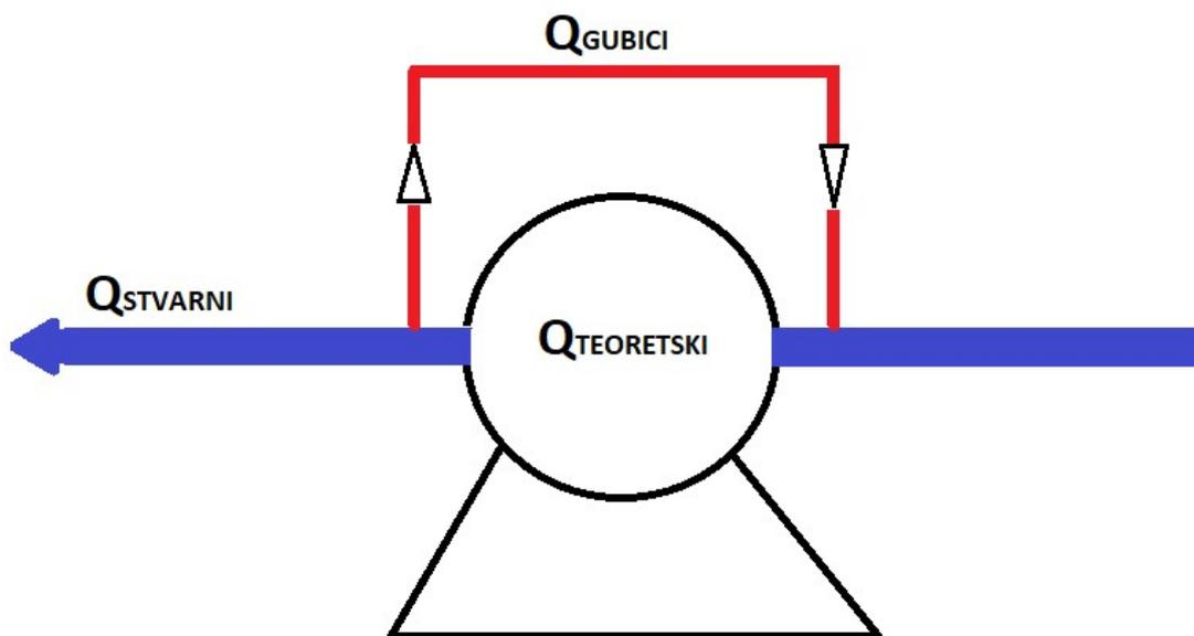
**Slika 24. Prikaz stvarnog protoka i gubitaka protoka zupčaste pumpe [8]**
