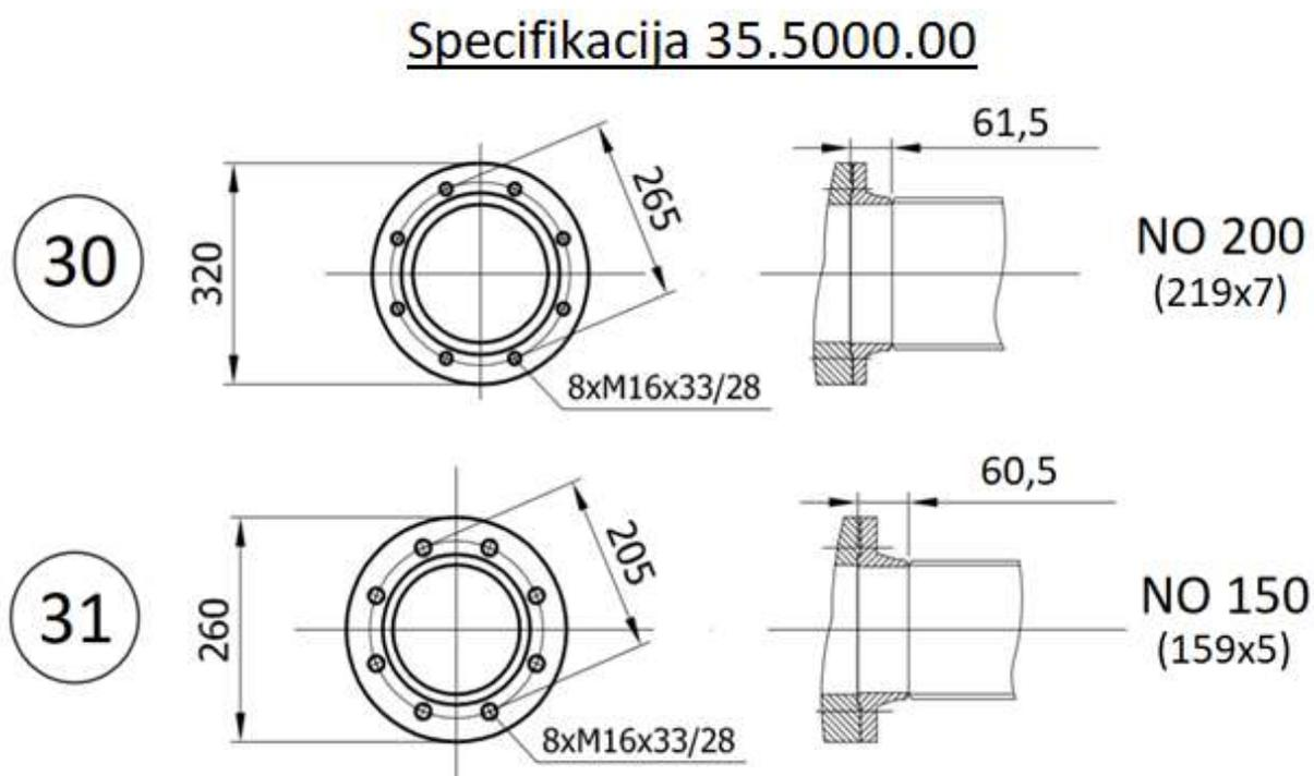
**Slika 11. Specifikacija plana priključaka zupčaste pumpe ulja na motoru [4]**
