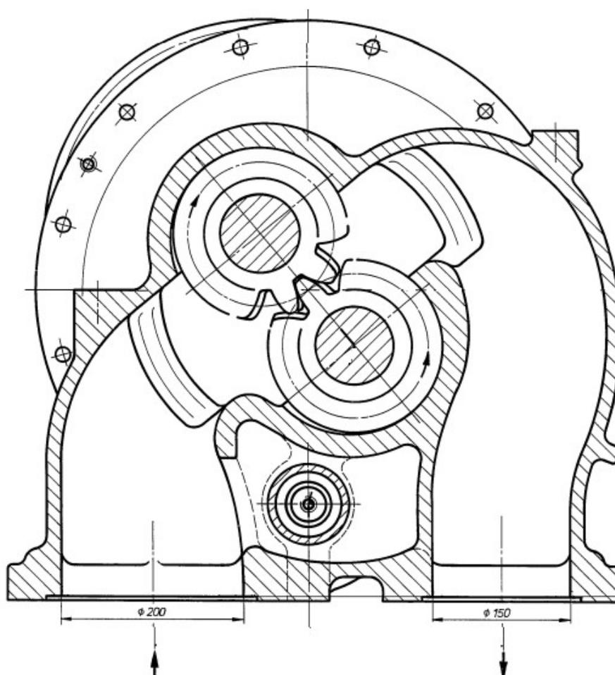
Slika 31. Izgled prigradene zupčaste pumpe [4]
