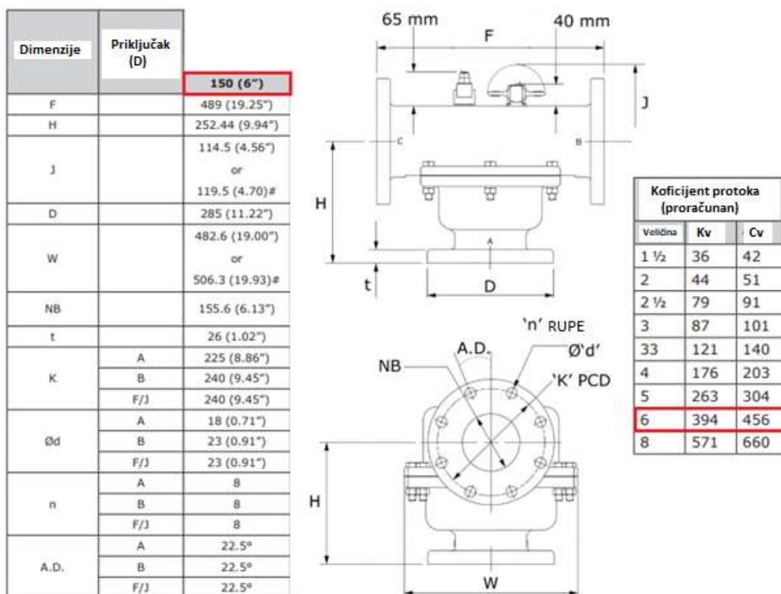
Slika 20. Kataloška specifikacija ventila 6BRDB model B [5]
