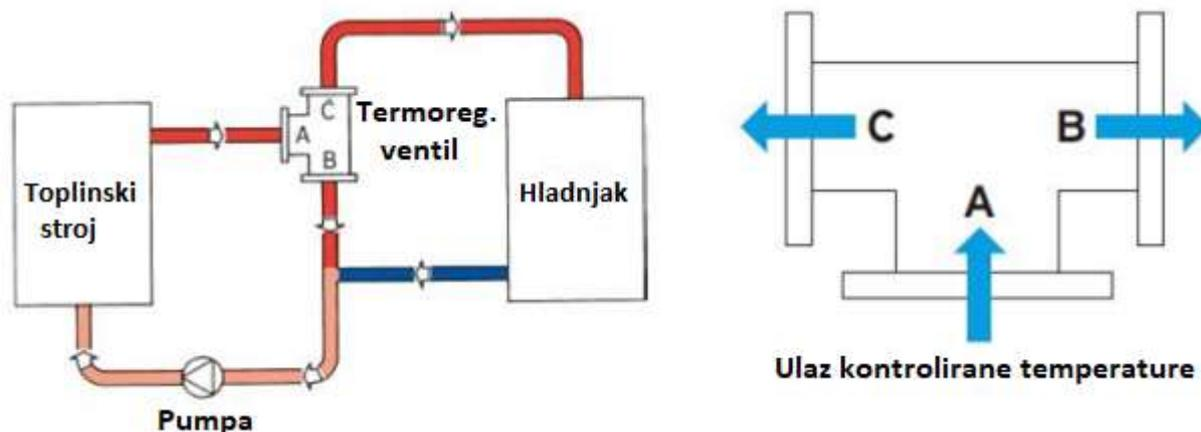
Slika 14. Shema rada ventila – preusmjeravanje radnog fluida [5]
