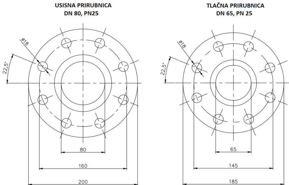
Slika 30. Usisna i tlačna prirubnica transfer pumpe ulja
