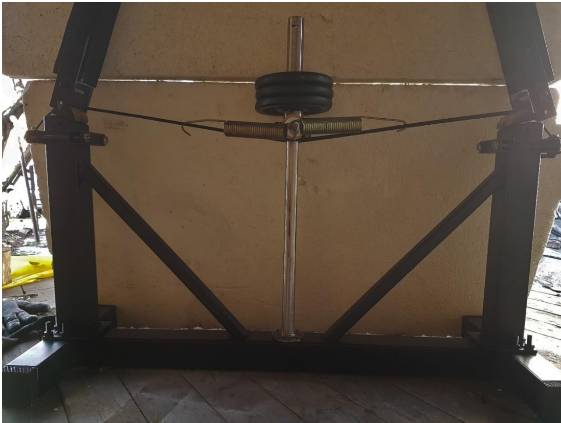
Slika 19. Mjerni uređaj: detalj utega i spoja s oprugama
