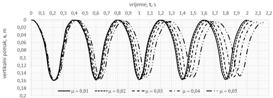
Slika 27. Utjecaj otpora na vodilici na vibracijski odziv
