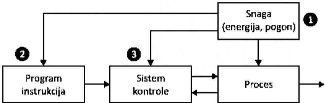
Slika 4. Automatizacija i kontrola tehnologija unutar proizvodnog sustava
