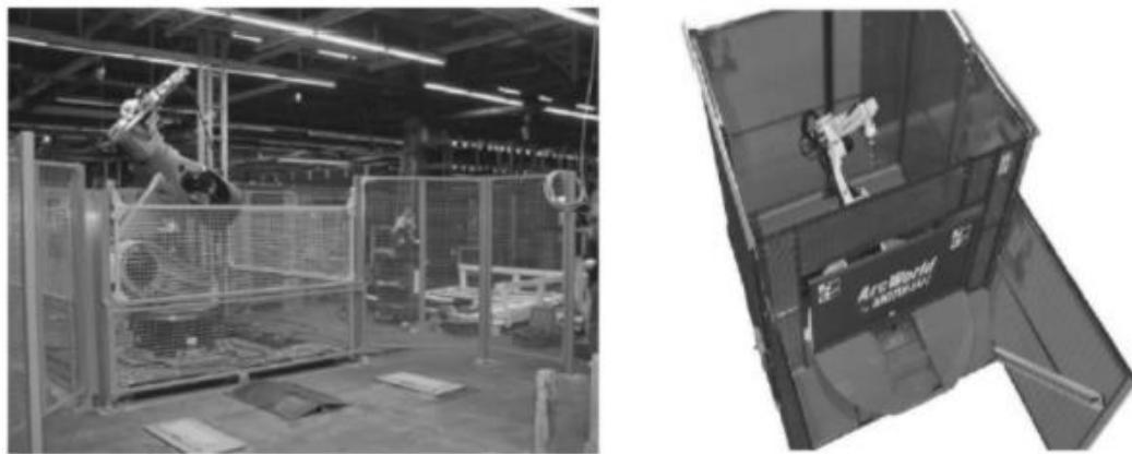
Slika 21. Zaštita radnog područja robota mehaničkom barijerom
