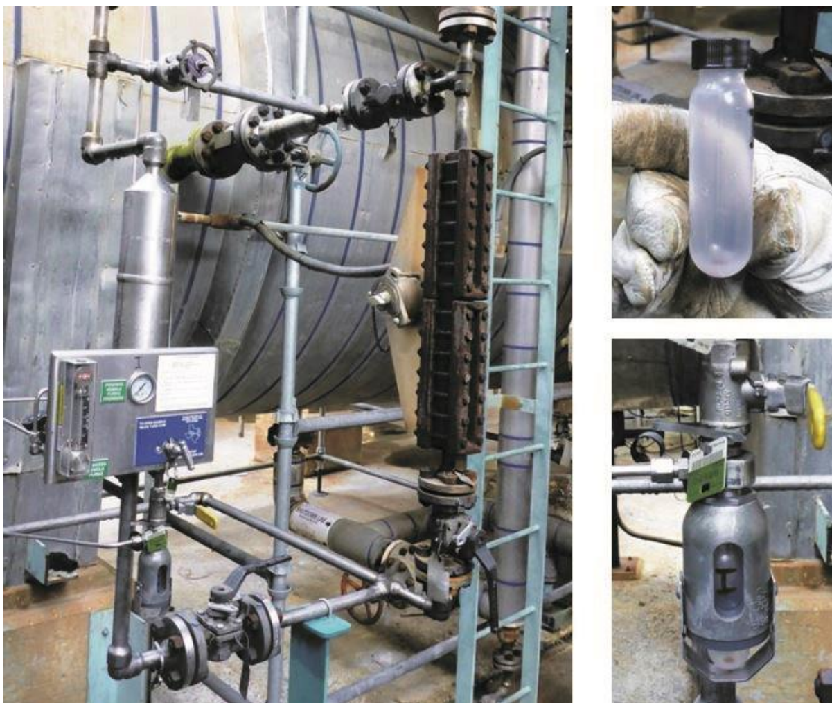
Slika 10: Fotografija uzorka sumporne kiseline u rafineriji tvrtke X. Fotografija s lijeve strane prikazuje tipičnu stanicu za uzorke koju radnici tvrtke X koriste za dobivanje uzoraka sumporne kiseline. Fotografija u gornjem desnom dijelu prikazuje tipičnu bocu s uzorcima, a fotografija u donjem desnom dijelu prikazuje bocu s uzorkom za postavljanje uzorka. [Proces safety culture case study Martinez, California, No. 2014-02-I-CA]
