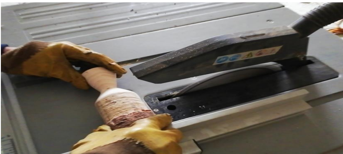
Slika 36. Uklanjanje obradka od viška materijala
