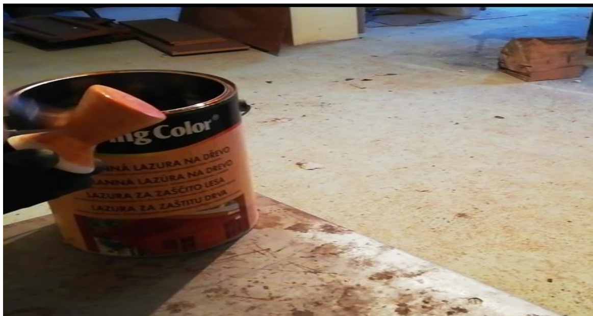
Slika 37. Premazivanje obradka sa lazuirom za zaštitu drva
