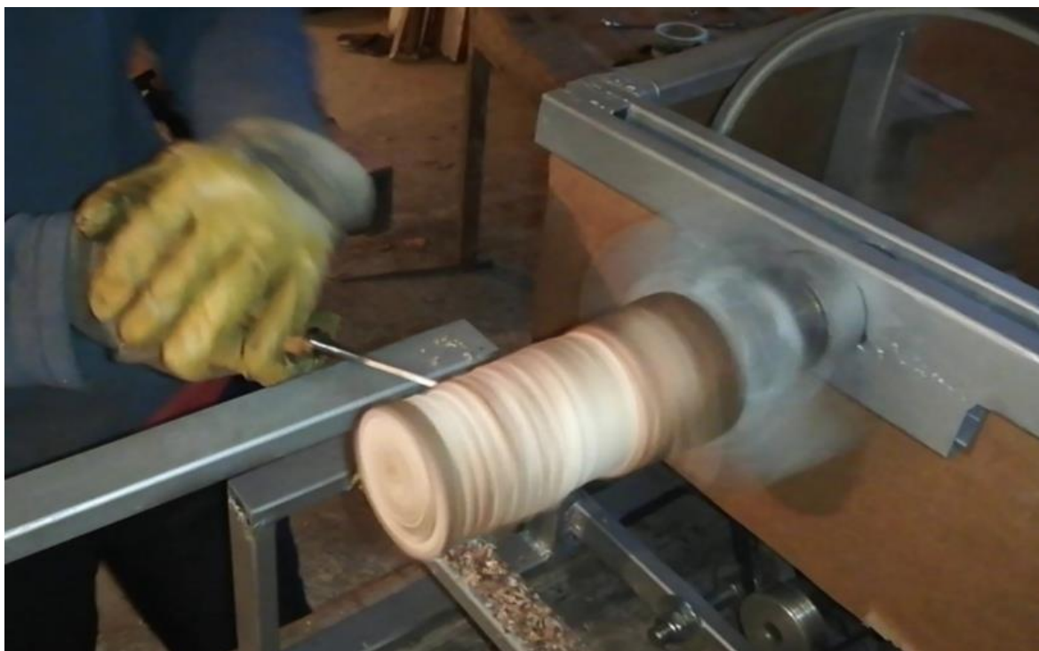
Slika 34. Obrada drva uz pomoću dlijeta
