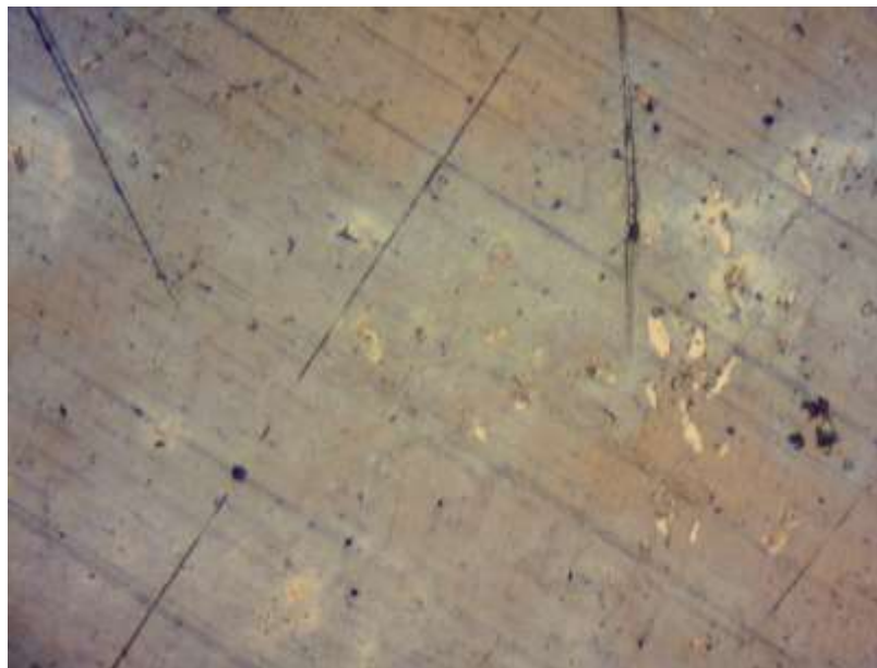
Slika 21. Površine čelika X6CrNiTi18-10 snimljene optičkim metalografskim mikroskopom (250X) nakon 60 dana izlaganja u 3% NaCl s dodatkom 2,5 g/L eutektičkog otapala kolin-klorid: limunska kiselina (ChCit).
