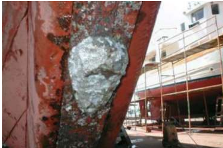
Slika 8. Katodna zaštita žrtvovanom anodom ( www.fsb.unizg.hr/korozija/ )
